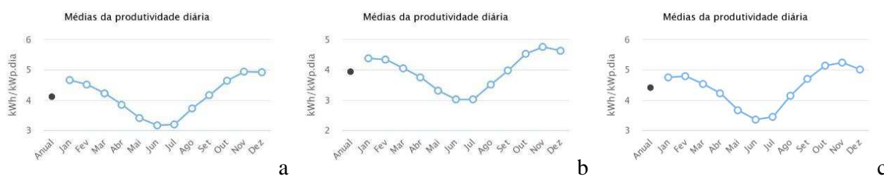
Figura 13. Médias da produtividade diária (kWh/kWp.dia) a) João Pessoa, b) Campina Grande, c) Patos.
