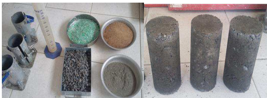
Figura 1. (a) Materiais usados para dosagem de concreto; (b) Desforma dos corpos de prova.
