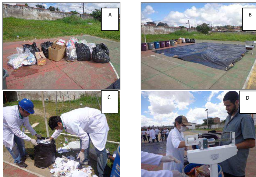
Figura 1. Procedimentos realizados para a composição gravimétrica dos resíduos: (A) Sacos plásticos com de resíduos; (B) Lona para espalhar os resíduos; (C) Separação; (D) Pesagem.
