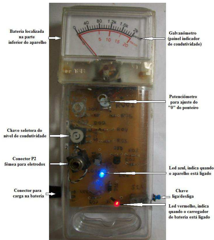
Figura 4. Condutivímetro analógico e suas partes principais.
