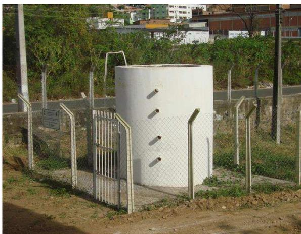
Figura 1. Lisímetro de RSU localizado na UFCG.
