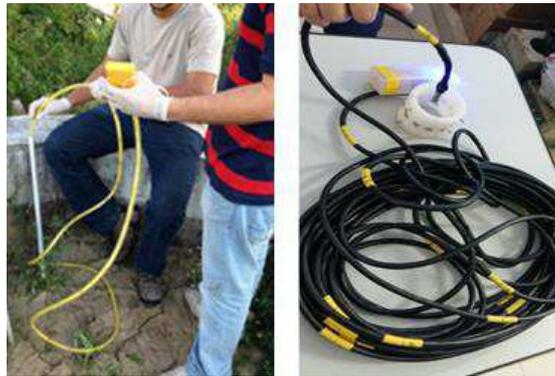
Figura 1. Sistemas de Medições de Recalques em Profundidade.
