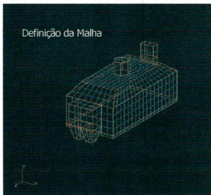
Figura 7.14 – Malha de resolução numérica construída com o build 4.2 do CFX - 4.4
