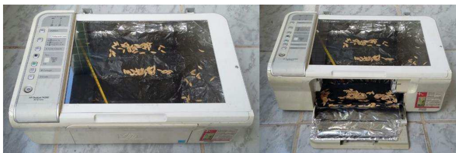
Figura 1. Protótipo do secador solar construído.
