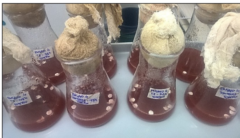
Figura 2 - Meio líquido em Erlenmeyers para avaliação da degradação do corante CI Direct Red 28 (Vermelho Congo) contendo o inóculo
