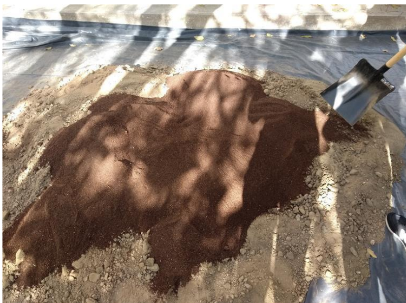
Figura 26. Homogeneização da mistura solo-composto orgânico.
