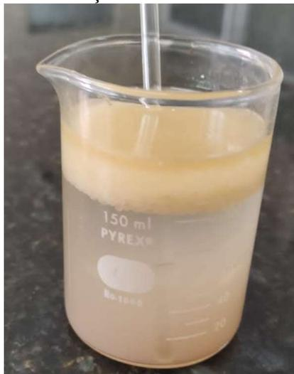
Figura 38 – Nanopartículas após modificação superficial com ácido oleico
