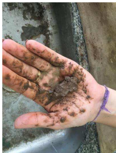
Figura 3. Análise tátil, método de dilatância.
