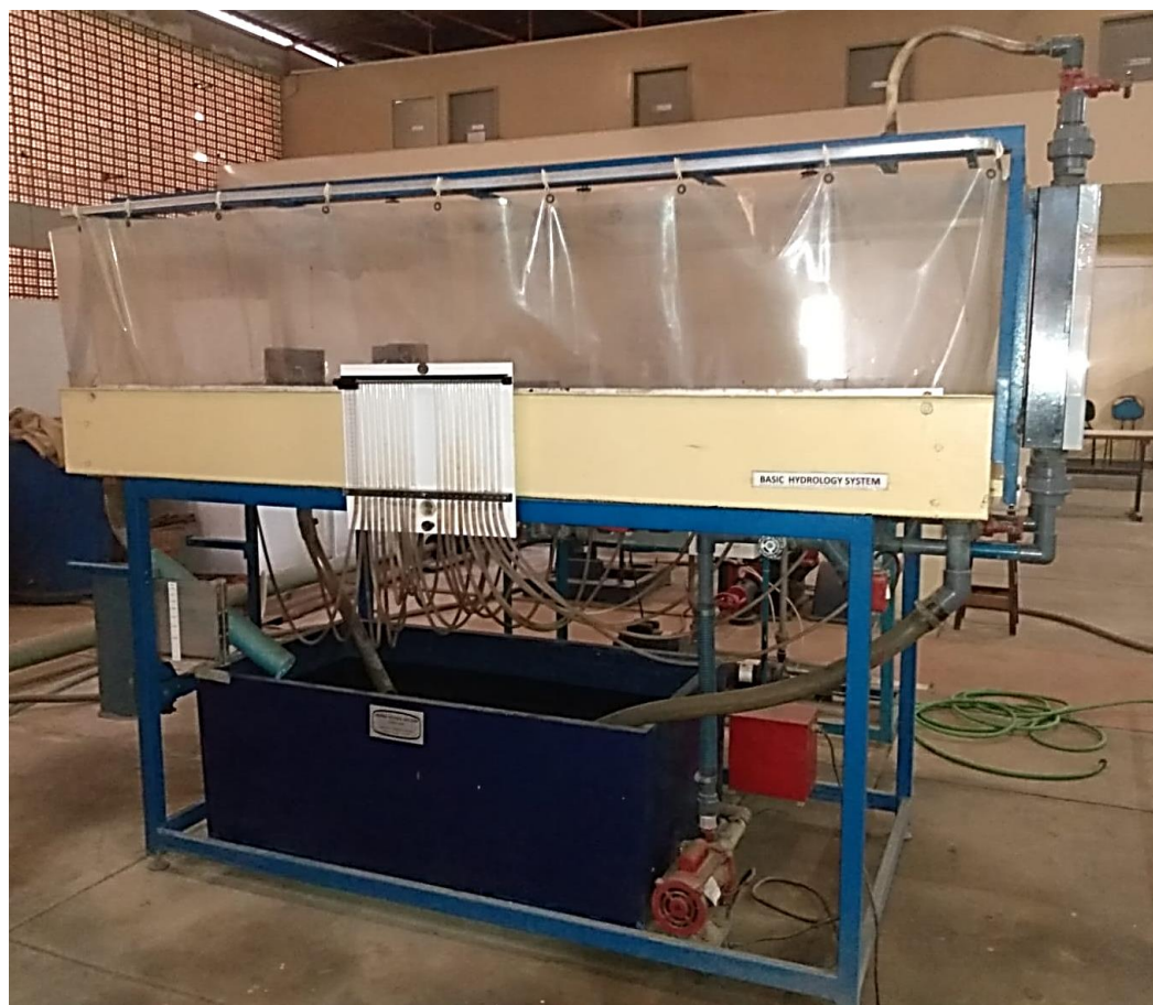
Figura 16 - Simulador de chuva aplicado para o envelhecimento das misturas asfálticas
