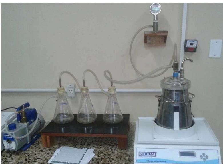
Com os corpos de prova pesados secos e submersos e de posse dos seus diâmetros e altura média é possível determinar os valores de Vv (volume de vazios), VAM (vazios no agregado mineral) e Gmm (massa específica máxima) e assim escolher a curva a ser
