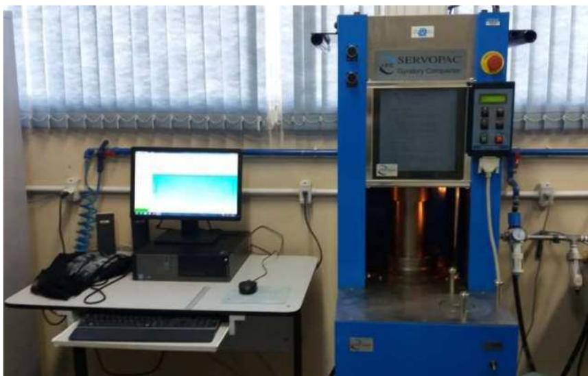
Outro parâmetro analisado foi densidade máxima medida (Gmm), determinada por meio do ensaio RICE TEST, segundo a norma ASTM D 2041. O equipamento utilizado para a realização do ensaio consta na Figura 16.
