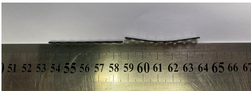
Como visto na Figura 57, após o ensaio, a placa de fixação óssea de aço apresentou-se curvada devido à plastificação do dispositivo médico durante o ensaio, enquanto a PFO de Ti-Nb, por apresentar superelasticidade, apresenta deformação residual praticamente imperceptível.
