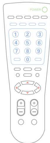
Figura 20 – Ilustração de um controle remoto com o uso de cores, tamanho e forma para agrupar funções
