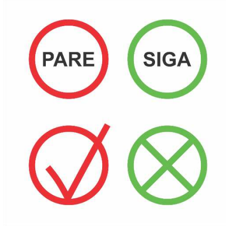
Figura 28 – Nas populações que aprenderam que verde significa siga e vermelho significa pare , a incongruência entre cor e rótulo/ícone produz interferência
