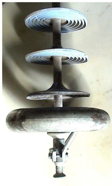
**Figura 5.8. Protótipo do anel equalizador proposto montado no isolador IC01S.**
