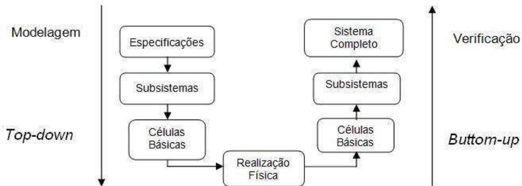
Figura 4.34. – Metodologias de projeto: *Top-down*, para modelagem e construção e *Bottom-up*, para verificação [76]
