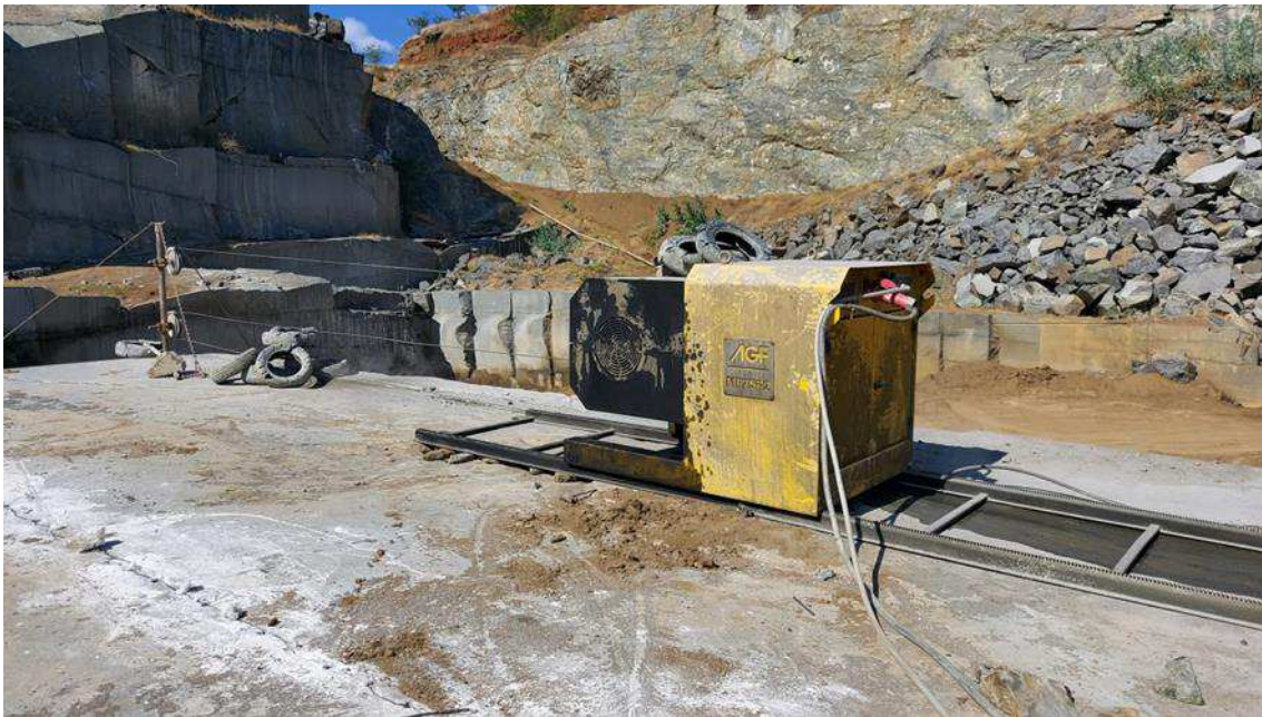
Figura 22: Corte para formação das pranchas com uso de fio-diamantado. Fonte: Autor, 2020.
