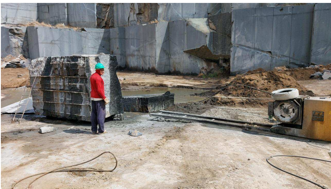
Figura 40: Acabamento das superfícies do bloco do uso de fio-diamantado. Fonte: Autor, 2020.
