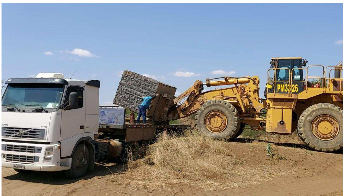
Figura 50: Carregamento de bloco em caminhão. Fonte: Autor, 2020.
