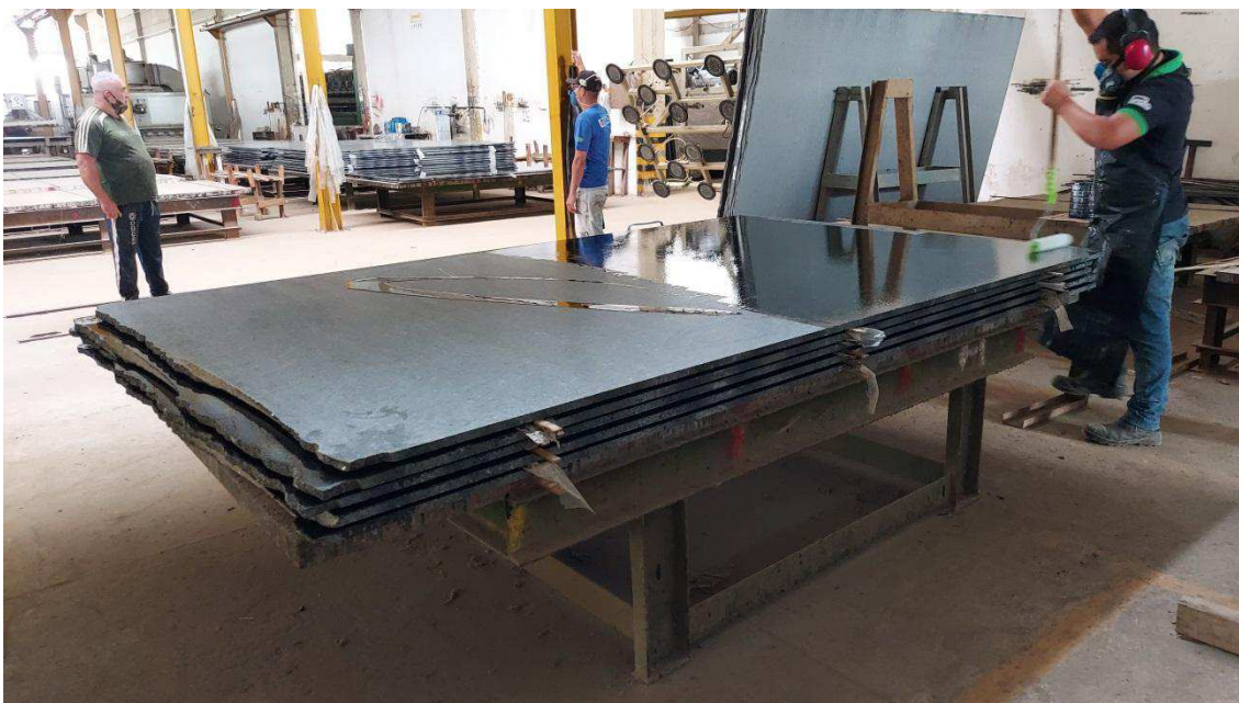
Figura 55: Resinagem manual. Fonte: Autor.
