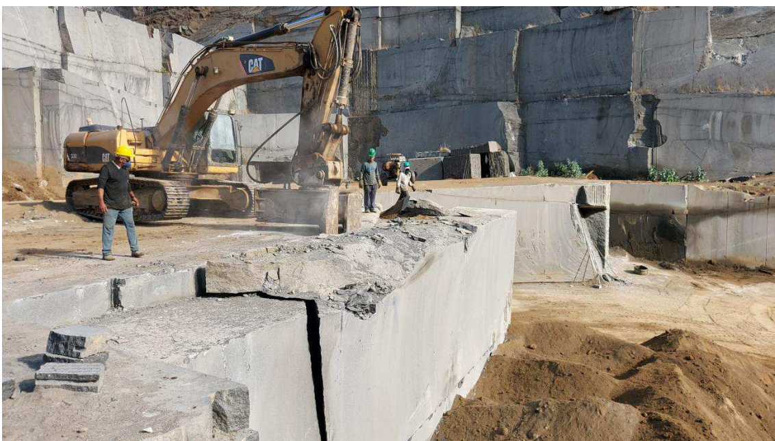
Figura 45: Expansor utilizado para tombamento de Prancha. Fonte: Autor, 2020.
