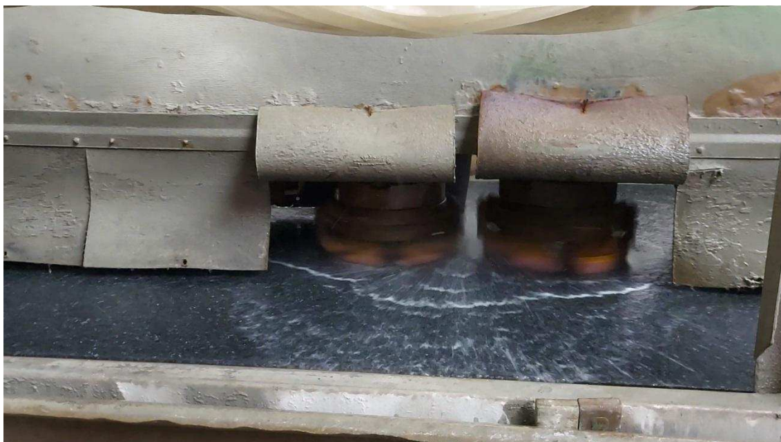
Figura 57: Satélites em operação de Levigamento. Fonte: Autor.
