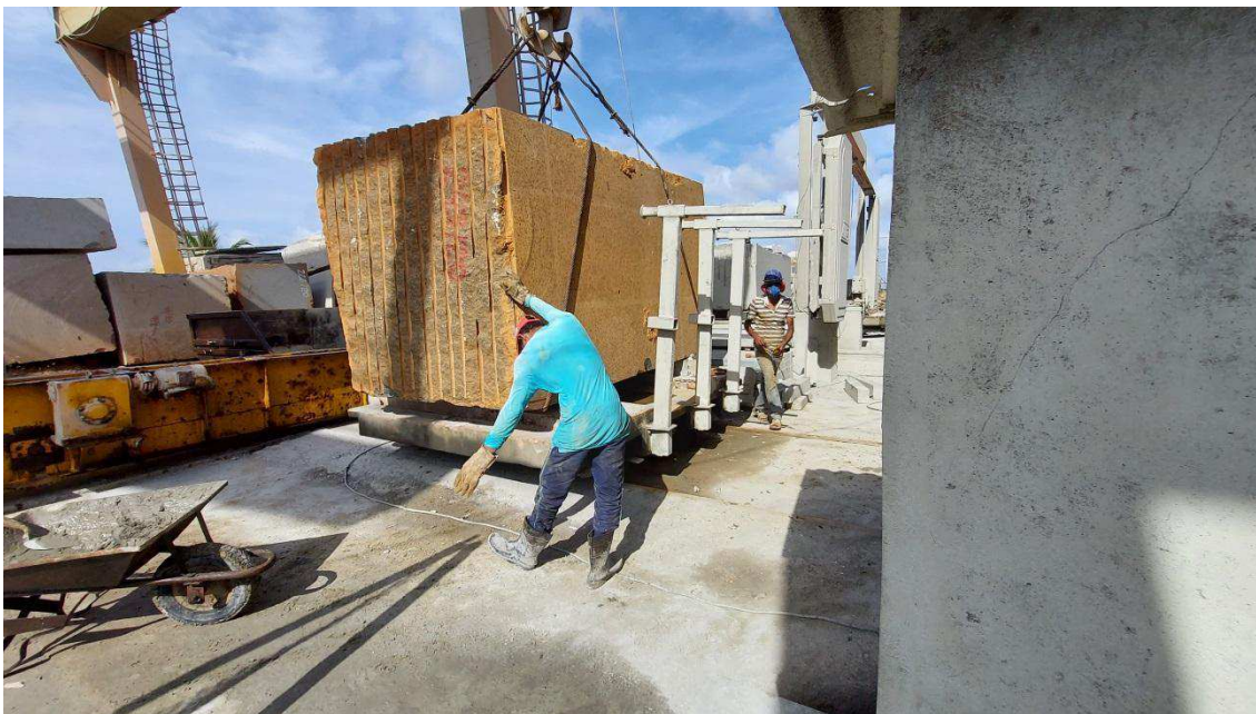
Figura 52: Carro sobre trilhos para transporte de blocos dentro da fábrica. Fonte: Autor.
