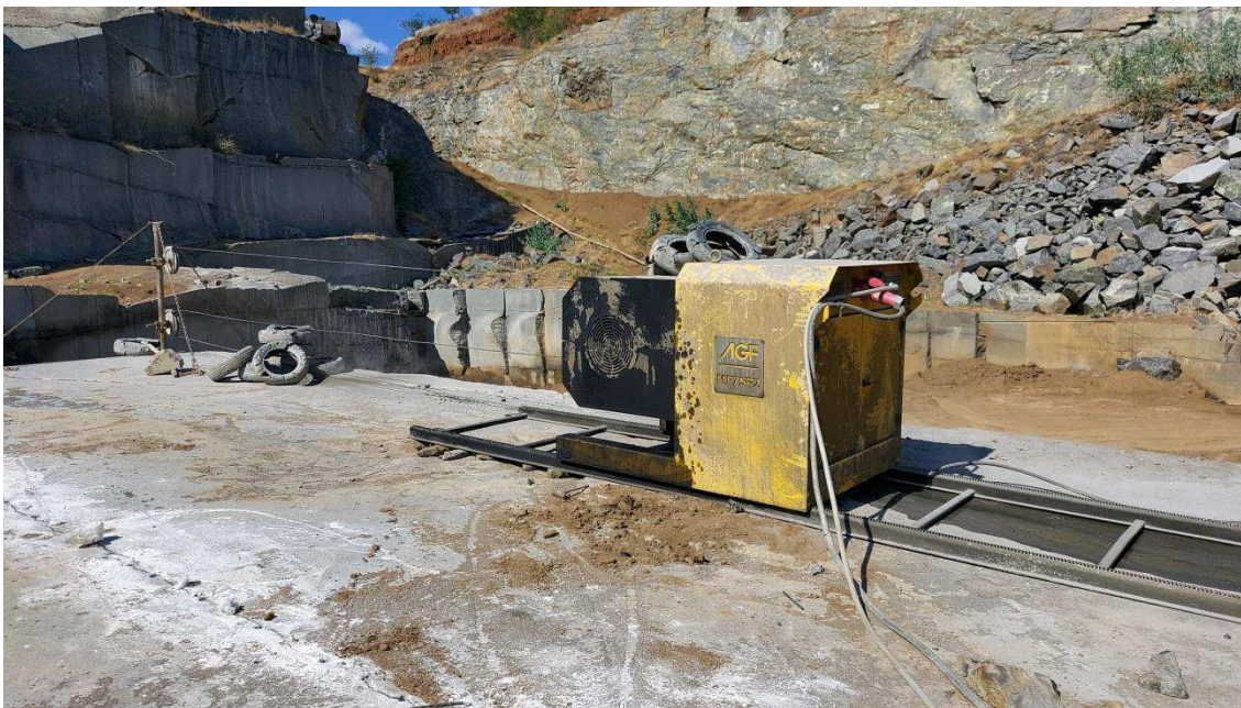
Figura 39: Corte para formação das pranchas com uso de fio-diamantado. Fonte: Autor, 2020.
