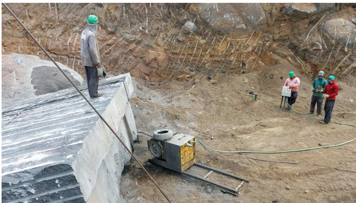
Figura 26: Corte por fio Diamantado em Matacão do Preto São Marcos, Casserengue – PB. Fonte: Autor, 2020.
