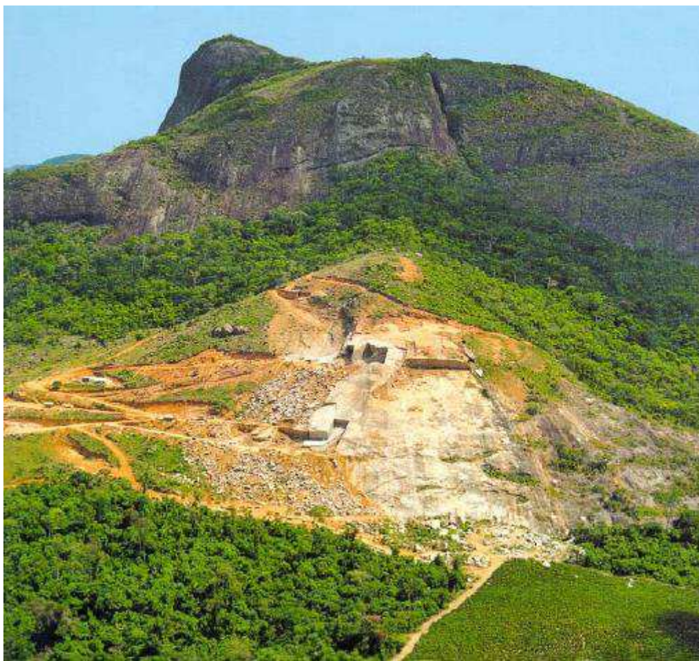
Figura 24: Lavra por desmoronamento. Granito “Giallo Speranza”, ES. (Fonte: Mineração Rocha Branca). Retirada de Menezes (2005).
