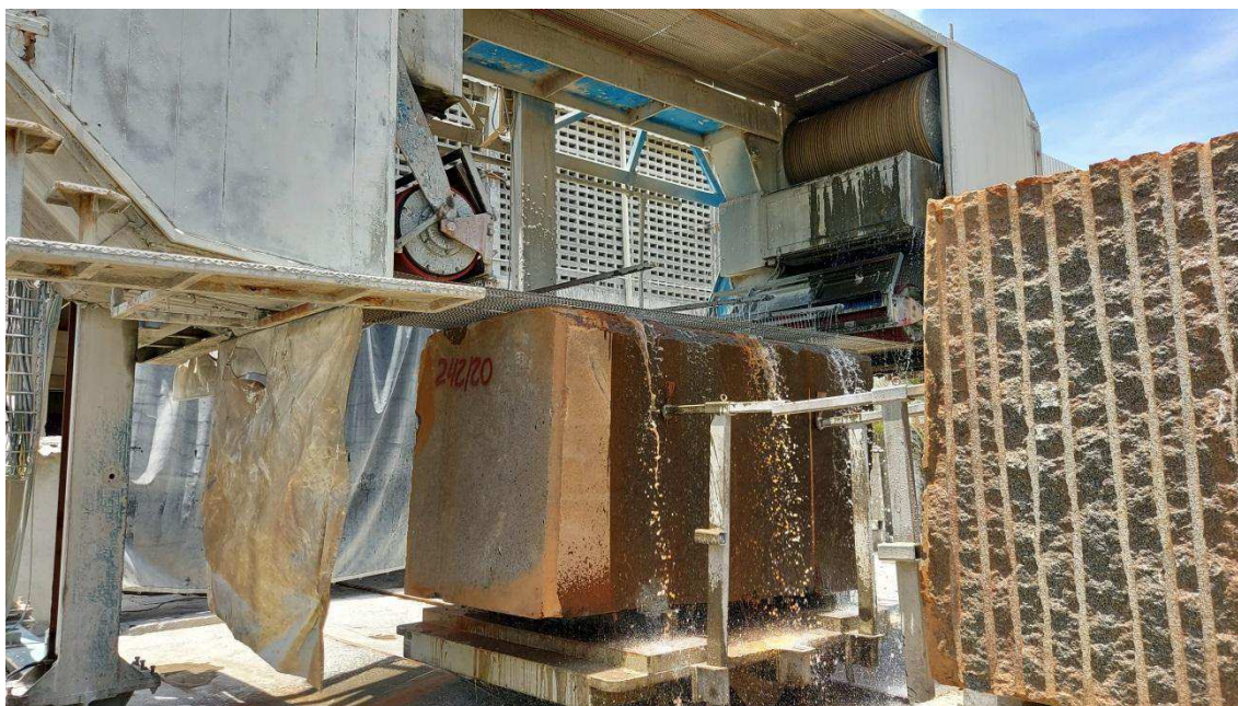
Figura 53: Corte de bloco com Multifio. Fonte: Autor.
