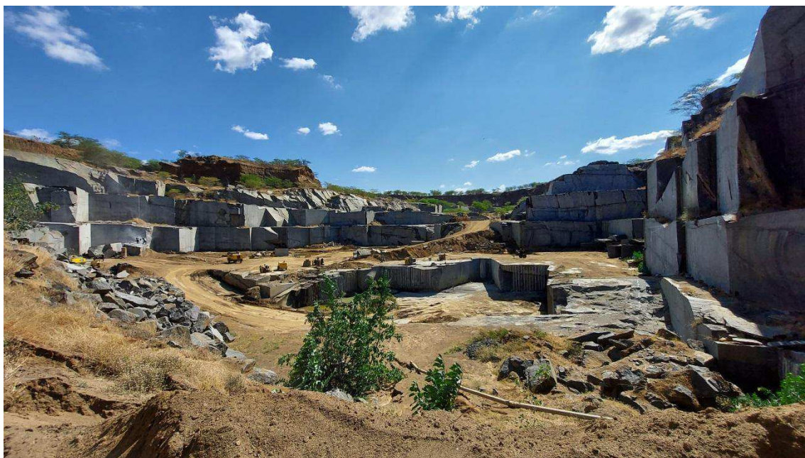
Figura 36: pedreira com método de bancadas altas. Fonte: Autor, 2020.
