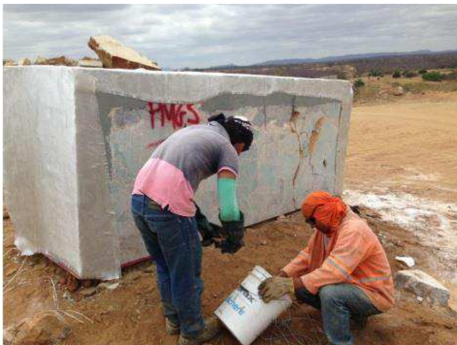
Figura 30: Envelopamento de blocos de Amazonita em Vieirópolis - PB. Fonte: Caldas & Ventura, 2019.
