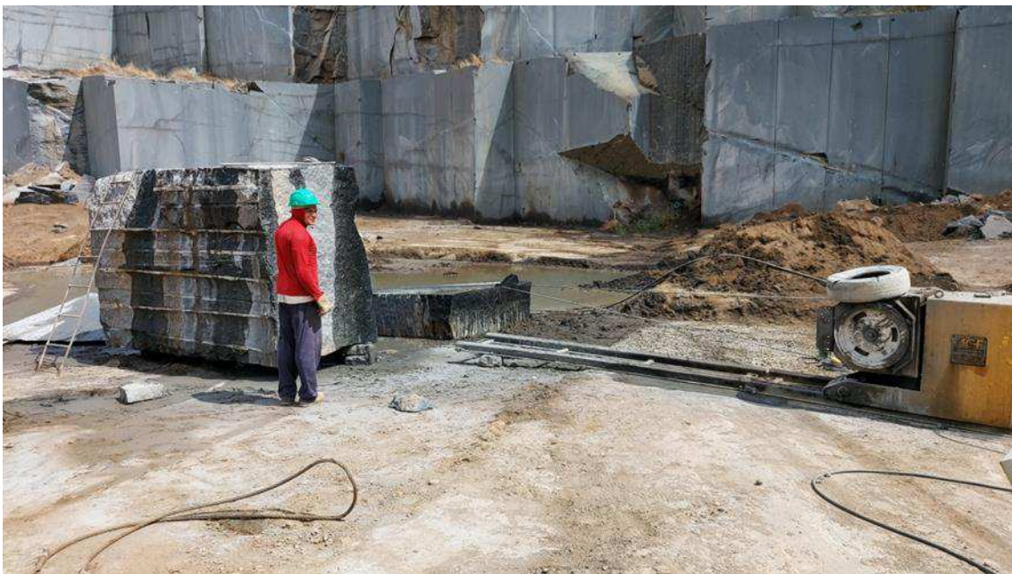
Figura 23: Acabamento das superfícies do bloco do uso de fio-diamantado. Fonte: Autor, 2020.
