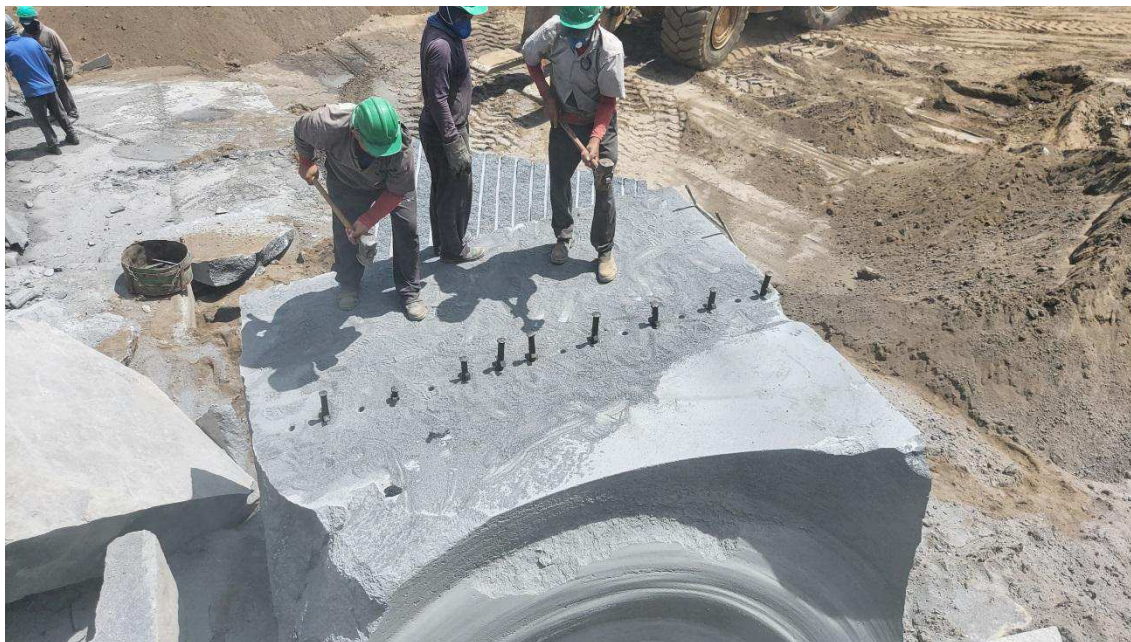
Figura 43: Uso de cunhas para rompimento da rocha. Fonte: Autor, 2020.
