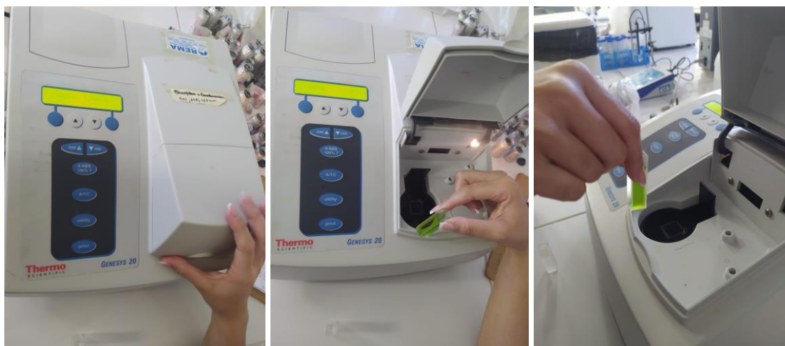
Figura 6. Avaliação dos teores de clorofila e carotenoides com utilizando-se um espectrofotômetro nos comprimentos de onda de absorvância (ABS) (470, 647 e 663).
