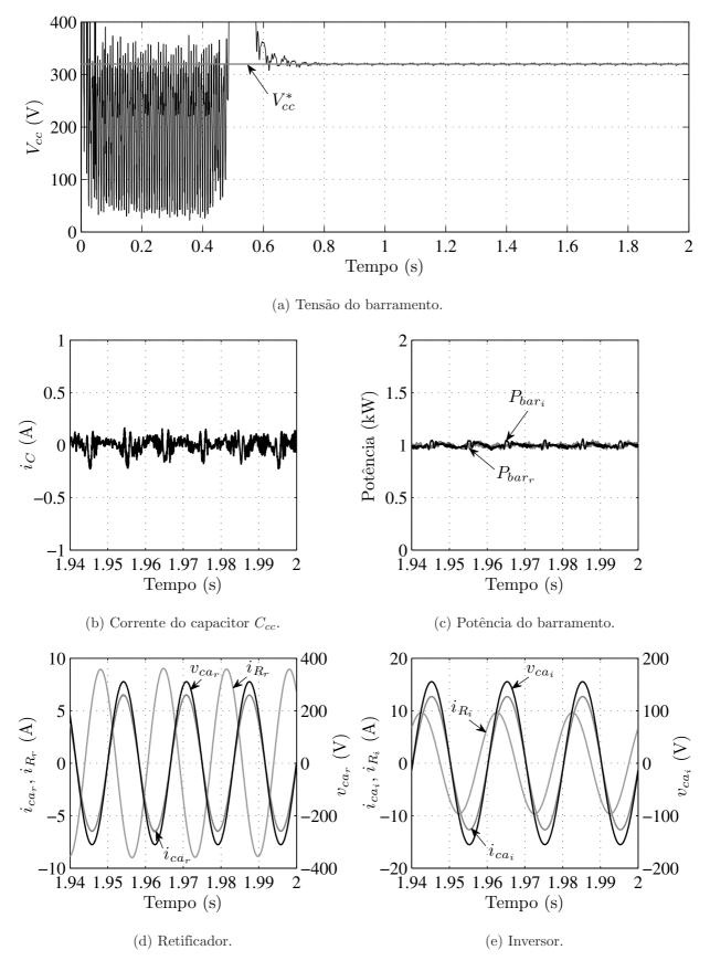
Figura 6.27: Resultado de simulação para o VSR-VSI abaixador com compensação da potência oscilatória.
