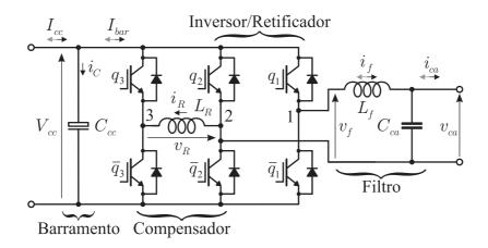
Figura 6.1: Circuito do VSC monofásico com compensador da potência oscilatória.
