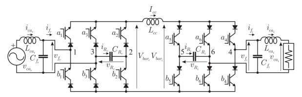
Figura 7.20: Topologia do CSR-CSI monofásico-monofásico com compensação da potência oscilatória.
