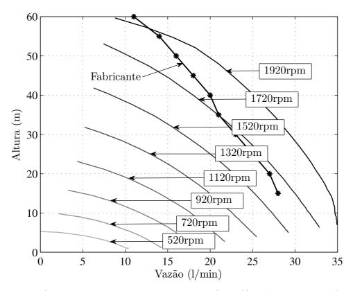
Figura 2.17: Curvas características experimentais  $(H \times Q)$  da bomba para diferentes velocidades.
