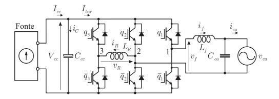
Figura 6.10: Circuito do VSI monofásico com compensador da potência oscilatória.
