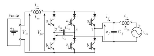
Figura 7.11: Circuito do CSI monofásico com compensador da potência oscilatória.
