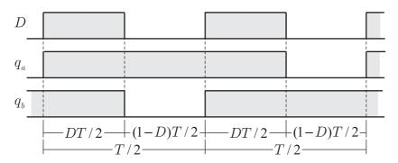
Figura 2.4: Formas dos pulsos de comando das chaves do push-pull.
