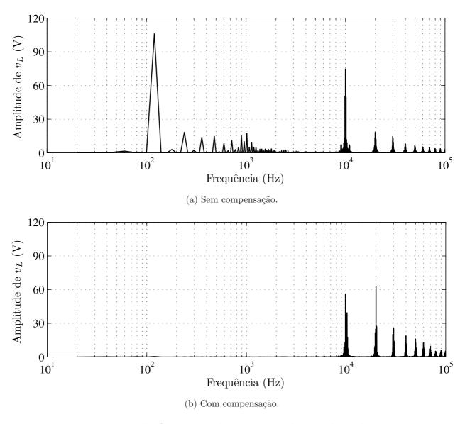
Figura 7.16: Espectro das frequências da tensão  $v_L$  sobre o indutor do barramento para o CSR.
