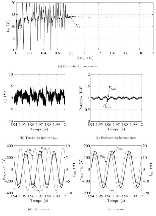
Figura 7.23: Resultado de simulação para o CSR-CSI abaixador com compensação da potência oscilatória.
