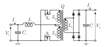
Figura 2.3: Diagrama elétrico do conversor push-pull.
