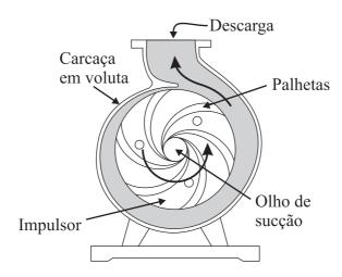
Figura 2.11: Trajetória do fluxo de líquido dentro de uma bomba centrífuga.
