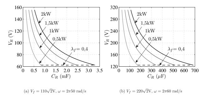
Figura 8.14: Amplitude da tensão no capacitor  $C_R$  em função da sua capacitância para diferentes valores de potência nominal de operação do conversor.
