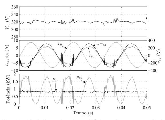
Figura 6.19: Resultado experimental para o VSR operando com compensação da potência oscilatória. De cima para baixo: tensão do barramento; formas de onda do lado CA; e potência no lado CA e CC.
