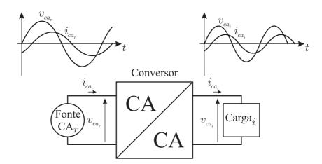
Figura 4.7: Características das formas de onda em um conversor CA-CC-CA.
