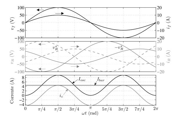
Figura 6.7: Formas de onda no VSR com compensação.
