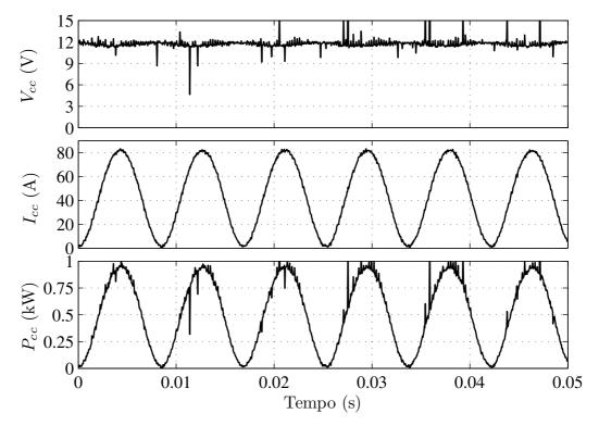
Figura 5.8: Resultado experimental para as variáveis de entrada do conversor comercial, onde  $V_{cc}$  é a tensão de entrada (V),  $I_{cc}$  é a corrente de entrada (A) e  $P_{cc}$  é a potência de entrada (W).
