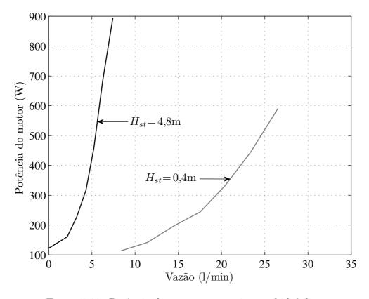
Figura 2.22: Potência do motor para o sistema hidráulico.
