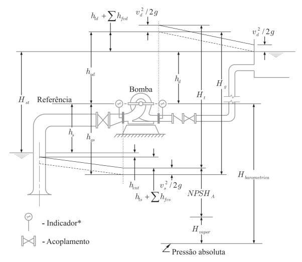
Figura 2.20: Terminologia para a bomba com uma altura de sucção negativa. (\*)
