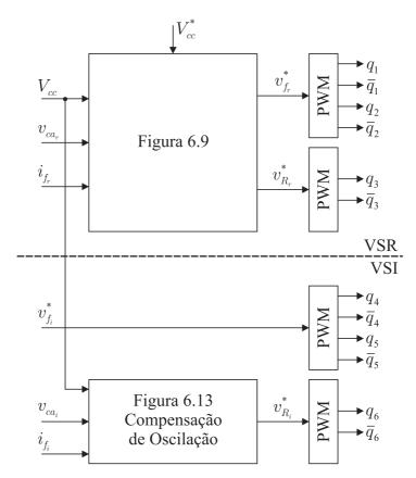
Figura 6.23: Diagrama de controle do VSR-VSI monofásico-monofásico com compensação da potência oscilatória.
