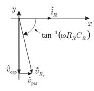
Figura 7.3: Tensão e corrente no capacitor real considerando a resistência parasita.
