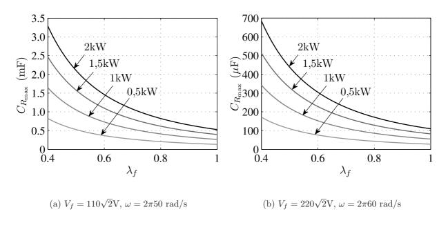
Figura 8.12: Capacitância máxima para  $C_R$  em função do índice de modulação para diferentes valores de potência nominal.
