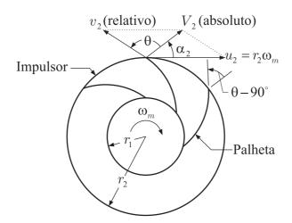
Figura 2.12: Diagrama de velocidade no impulsor da bomba. V, velocidade absoluta; v, velocidade relativa; u, velocidade linear;  $\alpha_1$ , ângulo para  $V_1$  no centro;  $\alpha_2$ , ângulo para  $V_2$  na periferia do impulsor;  $\theta$ , ângulo pra v na periferia do impulsor; e  $\omega_m$ , velocidade angular.
