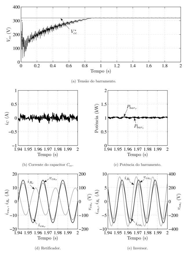
Figura 6.25: Resultado de simulação para o VSR-VSI elevador com compensação da potência oscilatória.
