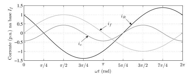
Figura 8.3: Formas de onda das correntes do VSC em p.u..
