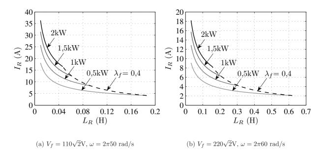
Figura 8.7: Amplitude da corrente no indutor  $L_R$  em função da sua indutância para diferentes valores de potência nominal de operação do conversor.
