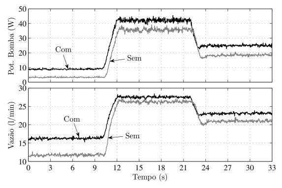
Figura 3.5: Resultado para o sistema de bombeamento operando sem e com otimização  $(\cos(\varphi))$ . Acima: potência hidráulica. Abaixo: vazão.
