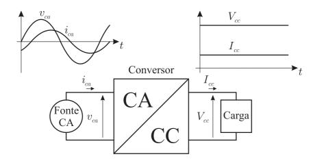
Figura 4.5: Característica das formas de onda em um conversor CA-CC.
