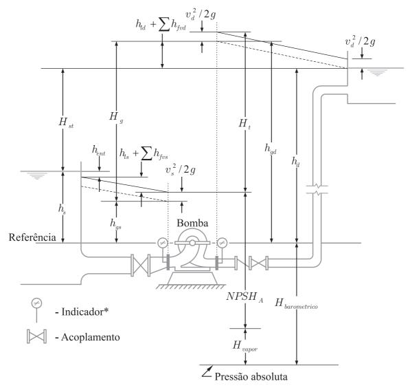
Figura 2.19: Terminologia para a bomba com uma altura de sucção positiva. (\*)
