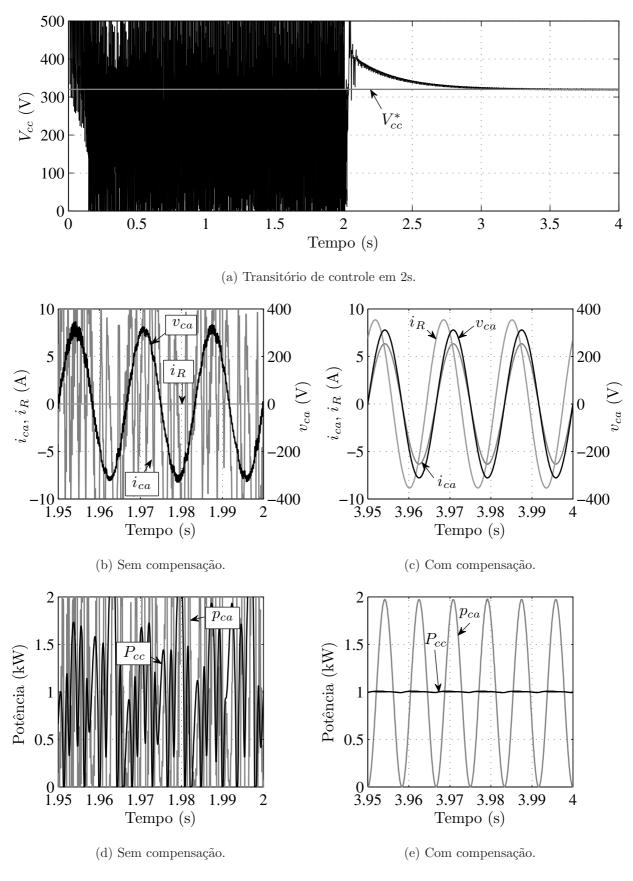
Figura 6.16: Resultado de simulação para o VSI com e sem compensação da potência oscilatória.
