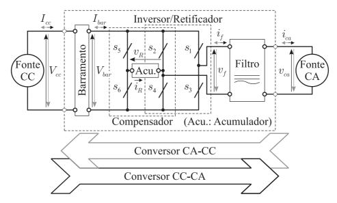
Figura 5.2: Conversor monofásico generalizado com compensação da potência oscilatória.
