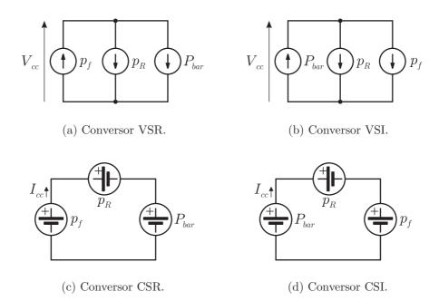
Figura 5.3: Fluxo de potência no conversor monofásico com compensação da potência oscilatória.
