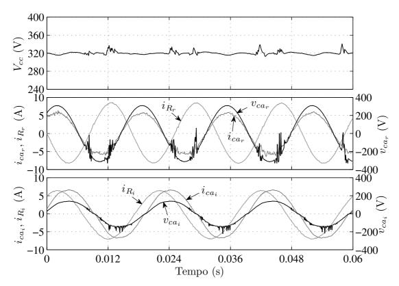
Figura 6.28: Resultado experimental para o VSR-VSI abaixador com compensação da potência oscilatória. De cima para baixo: tensão do barramento; formas do onda do lado CA do retificador; e formas de onda do lado CA do inversor.
