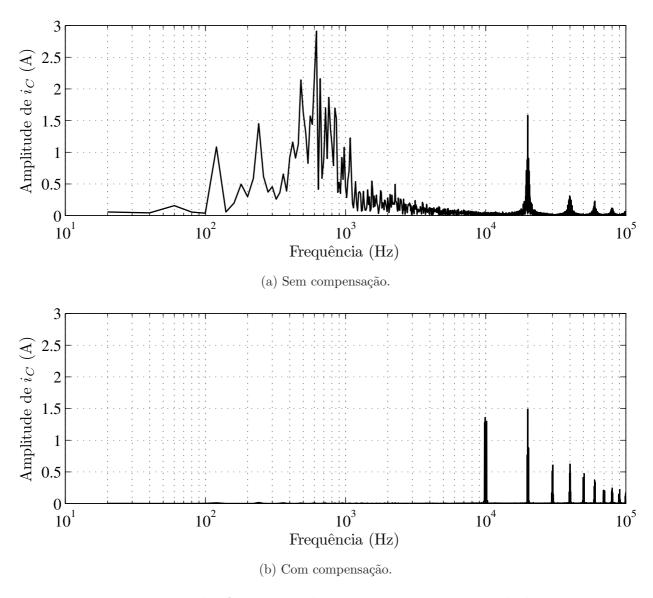
Figura 6.17: Espectro das frequências da corrente  $i_C$  do capacitor do barramento para o VSI.
