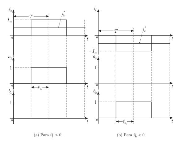
Figura 4.14: Tempos de chaveamento para a PWM no CSC.
