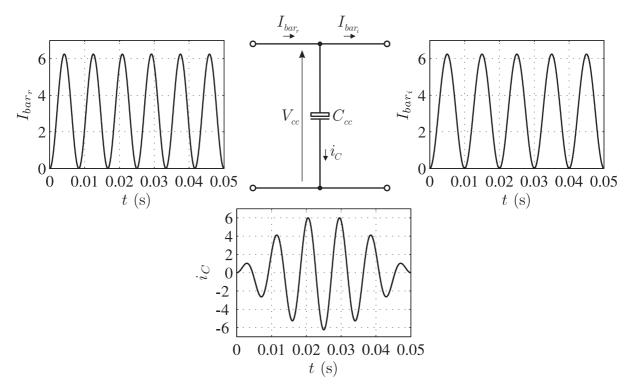
Figura 6.21: Forma de onda das correntes no barramento CC do VSR-VSI monofásico-monofásico.
