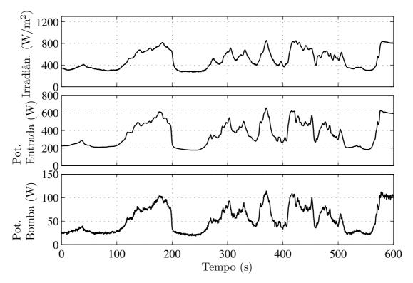
Figura 3.9: Potência do sistema operando com otimização (correntes iguais). De cima para baixo: perfil de irradiância; potência fornecida pelos geradores fotovoltaicos; e potência hidráulica.
