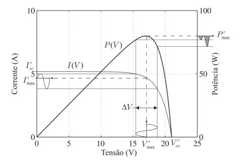
Figura 1.3: Ilustração do efeito da oscilação de baixa frequência na busca pelo ponto de máxima potência em um sistema fotovoltaico.
