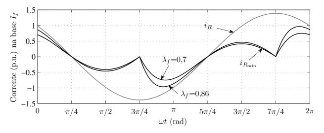
Figura 8.4: Corrente mínima e corrente praticada no indutor de compensação do VSC em p.u..
