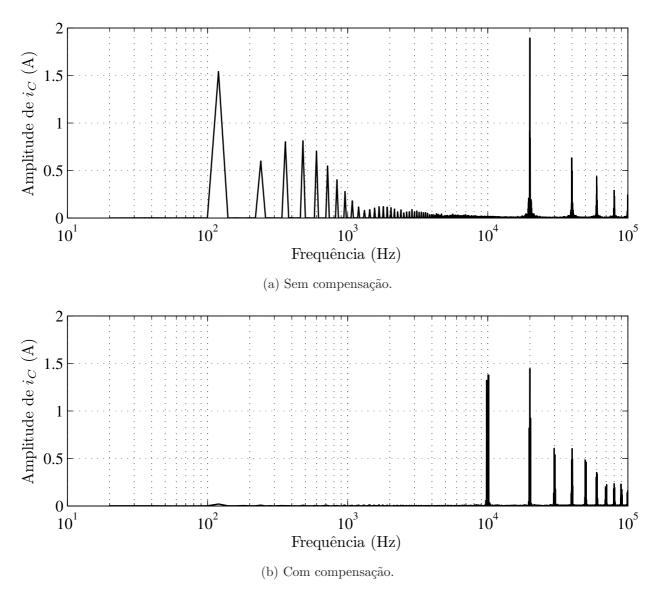
Figura 6.15: Espectro das frequências da corrente  $i_C$  do capacitor do barramento para o VSR.
