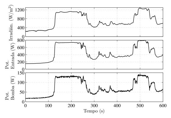
Figura 3.8: Potência do sistema operando com otimização  $(\cos(\varphi))$ . De cima para baixo: perfil de irradiância; potência fornecida pelos geradores fotovoltaicos; e potência hidráulica.
