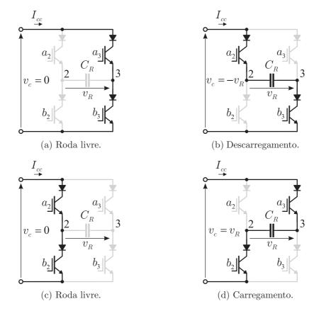
Figura 8.9: Estágios de chaveamento no conversor de compensação para  $v_R < 0$ .
