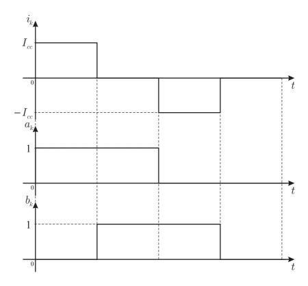
Figura 4.13: Corrente de entrada/saída do CSC básico.
