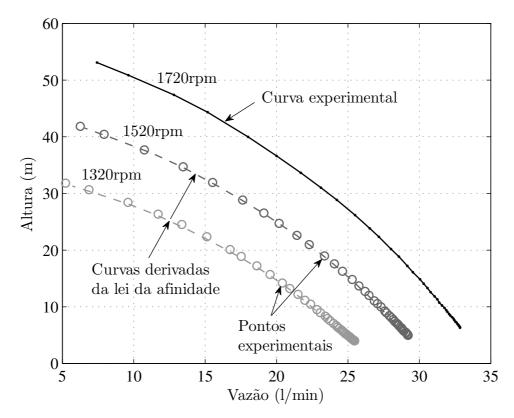
Figura 2.14: Curvas da bomba desenvolvidas a partir da lei da afinidade comparadas com o resultado experimental.
