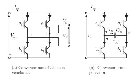
Figura 7.2: Partes do CSC monofásico com compensação da potência oscilatória.
