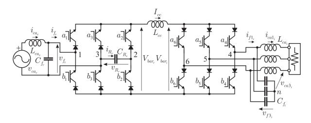
Figura 7.24: Topologia do CSR-CSI monofásico-trifásico com compensação da potência oscilatória.
