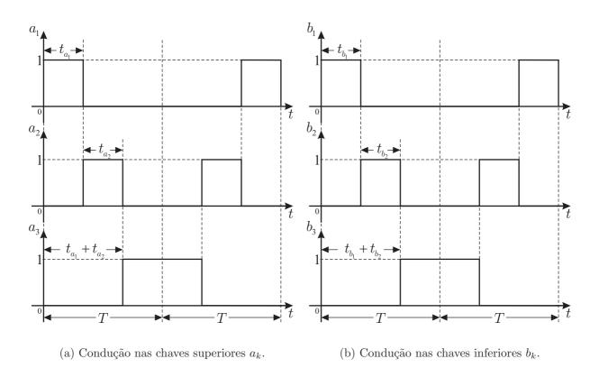
Figura 7.5: Sequência e tempos de condução para a PWM no CSC com três fases.
