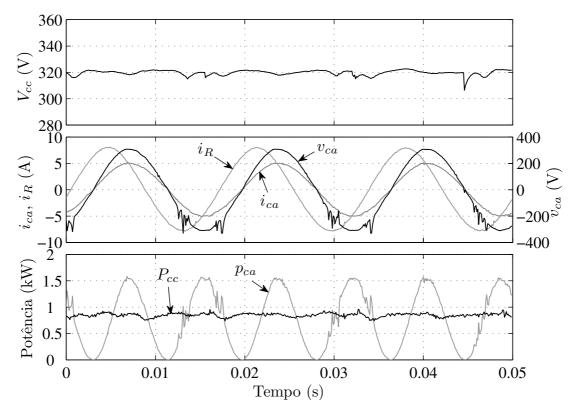
Figura 6.20: Resultado experimental para o VSI operando com compensação da potência oscilatória. De cima para baixo: tensão do barramento; formas de onda do lado CA; e potência no lado CA e CC.
