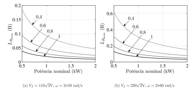
Figura 8.6: Indutância máxima para  $L_R$  em função da potência nominal de operação do conversor para diferentes valores de índice de modulação  $\lambda_f$ .
