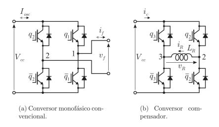
Figura 6.2: Partes do VSC monofásico com compensação da potência oscilatória.
