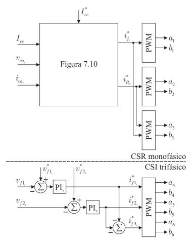
Figura 7.25: Diagrama de controle do CSR-CSI monofásico-trifásico com compensação da potência oscilatória.
