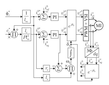
(b) IFOC modificado tensão de eixo-q.
