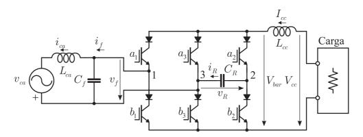
Figura 7.6: Circuito do CSR monofásico com compensador da potência oscilatória.
