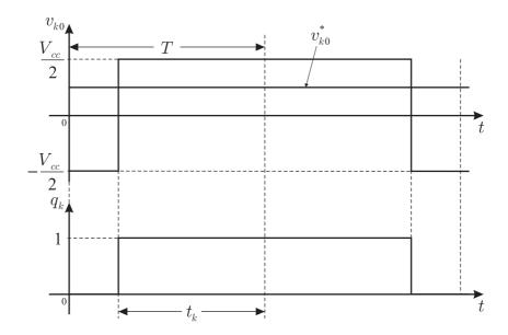
Figura 4.10: Tempos de chaveamento para a PWM no VSC.
