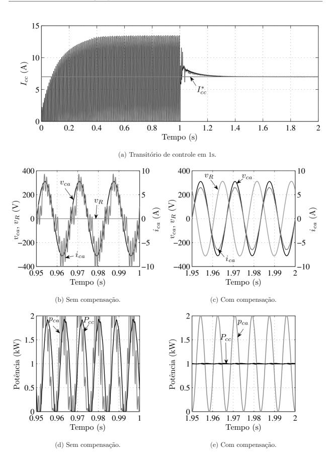
Figura 7.15: Resultado de simulação para o CSR com e sem compensação da potência oscilatória.
