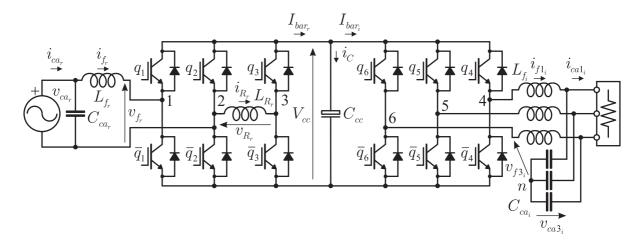
Figura 6.29: Topologia do VSR-VSI monofásico-trifásico com compensação da potência oscilatória.
