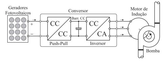
Figura 1.1: Diagrama de blocos do sistema de bombeamento utilizado.
