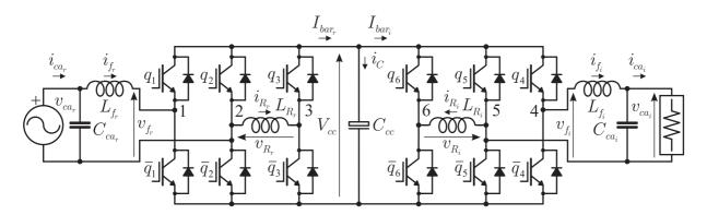
Figura 6.22: Topologia do VSR-VSI monofásico-monofásico com compensação da potência oscilatória.
