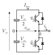
Figura 4.9: Configuração do braço de um VSC.
