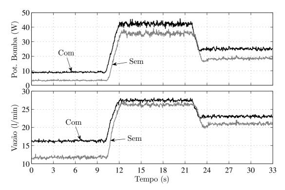
Figura 3.6: Resultado para o sistema de bombeamento operando sem e com otimização (equal). Acima: potência hidráulica. Abaixo: vazão.
