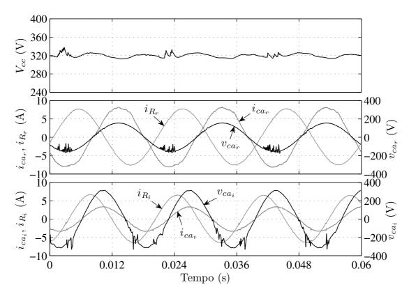
Figura 6.26: Resultado experimental para o VSR-VSI elevador com compensação da potência oscilatória. De cima para baixo: tensão do barramento; formas de onda do lado CA do retificador; e formas de onda do lado CA do inversor.
