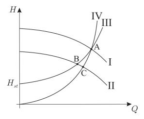
Figura 2.13: Curvas  $H \times Q$  da bomba para velocidades diferentes.
