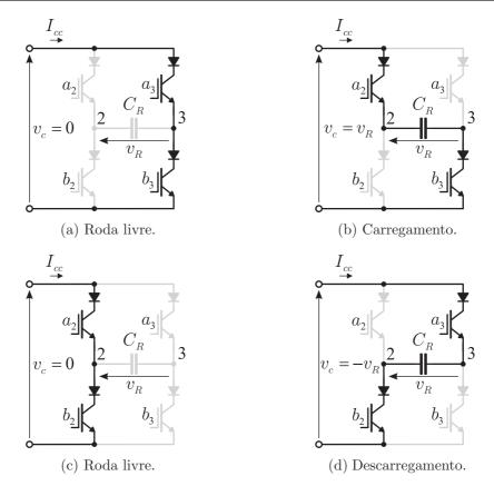
Figura 8.8: Estágios de chaveamento no conversor de compensação para  $v_R>0.$
