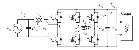
Figura 6.5: Circuito do VSR monofásico com compensador da potência oscilatória.
