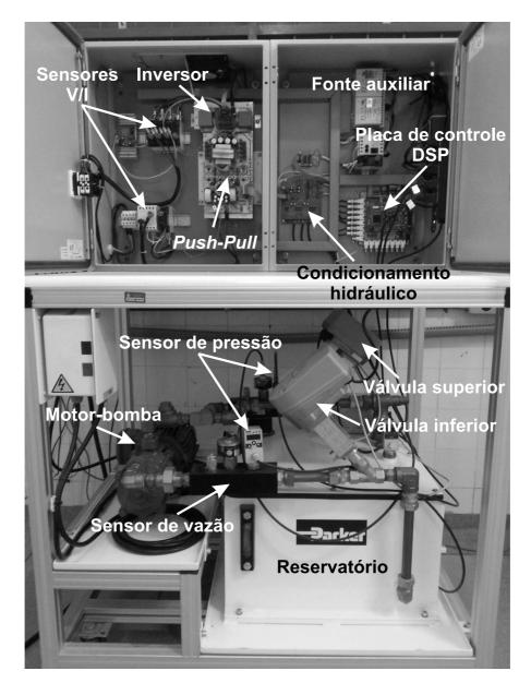
Figura 3.3: Plataforma experimental para obtenção dos resultados para o sistema de bombeamento fotovoltaico.
