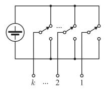
Figura 4.8: Concepção do inversor/retificador VSC com k fases.
