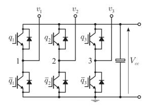
Figura 2.7: Esquema elétrico do inversor trifásico.
