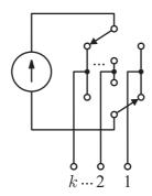
Figura 4.11: Concepção do inversor/retificador CSC com k fases.
