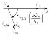
Figura 6.3: Tensão e corrente no indutor real considerando a resistência parasita.
