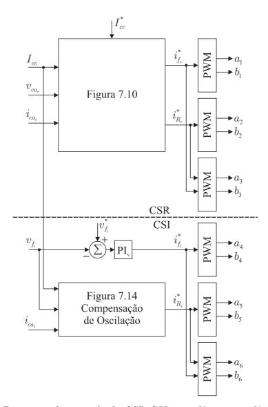
Figura 7.21: Diagrama de controle do CSR-CSI monofásico-monofásico com compensação da potência oscilatória.
