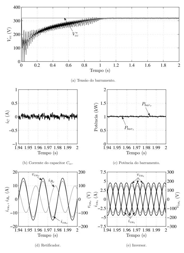
Figura 6.31: Resultado de simulação para o VSR-VSI monofásico-trifásico elevador com compensação da potência oscilatória.
