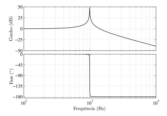
Figura 4.18: Resposta em frequência do filtro passa-baixa RLC.
