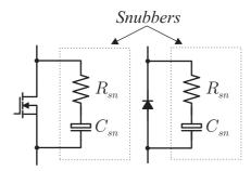
Figura 2.6: Diagrama elétrico para os *snubbers* das chaves e diodos.
