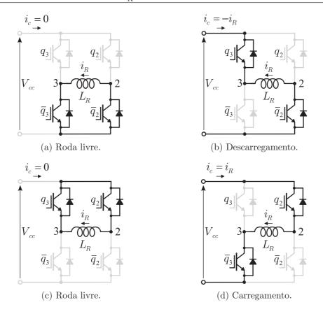
Figura 8.1: Estágios de chaveamento no conversor de compensação para  $i_R>0.$
