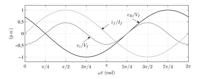
Figura 8.10: Formas de onda das tensões do CSC em p.u..
