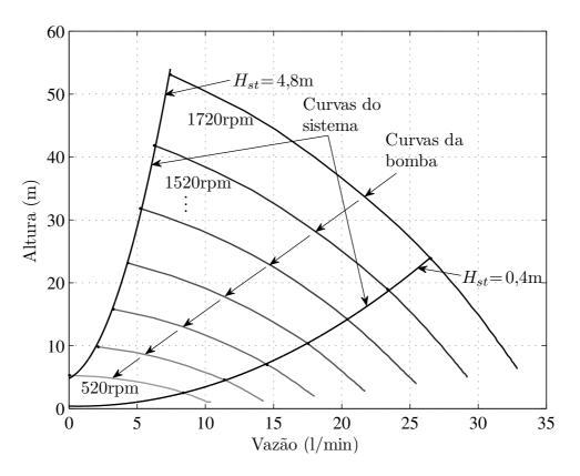
Figura 2.21: Curvas características do sistema hidráulico.
