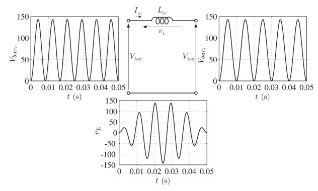
Figura 7.19: Forma de onda das tensões no barramento CC do CSR-CSI monofásico-monofásico.
