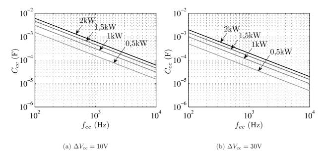
Figura 8.15: Capacitância  $C_{cc}$  em função da frequência das correntes do barramento para diferentes valores de potência nominal.  $V_{cc}=320$ .
