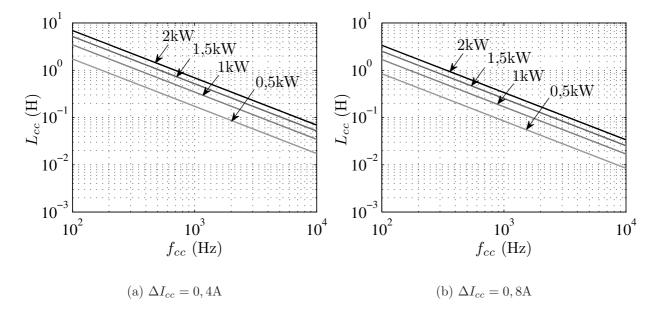
Figura 8.16: Indutância  $L_{cc}$  em função da frequência das tensões do barramento para diferentes valores de potência nominal.  $I_{cc} = 7$ .
