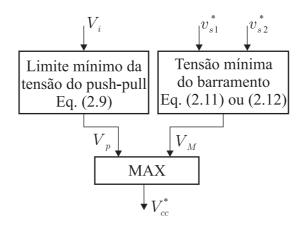
Figura 2.8: Critério de escolha para a tensão do barramento CC.
