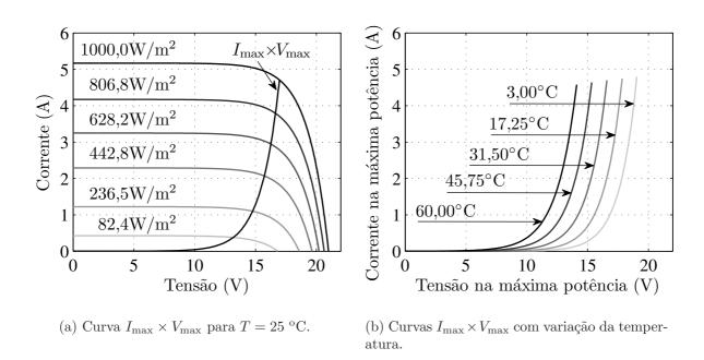
Figura 2.2: Pontos de máxima potência de um gerador fotovoltaico.
