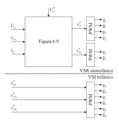
Figura 6.30: Diagrama de controle do VSR-VSI monofásico-trifásico com compensação da potência oscilatória.
