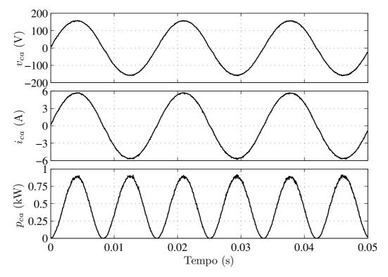
Figura 5.9: Resultado experimental para as variáveis de saída do conversor comercial, onde  $v_{ca}$  é a tensão de saída (V),  $i_{ca}$  é a corrente de saída (A) e  $p_{ca}$  é a potência de saída (W).
