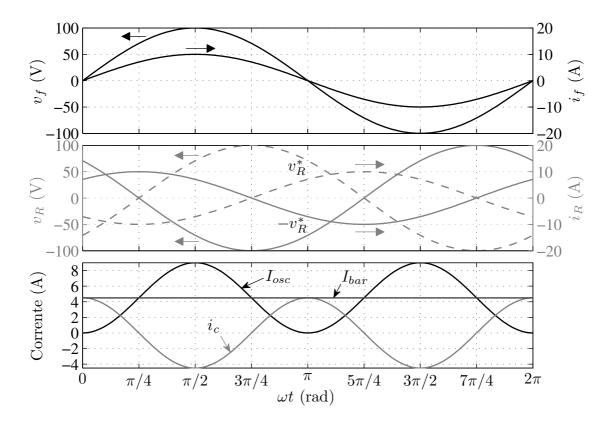
Figura 6.12: Formas de onda no VSI com compensação.
