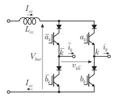
Figura 4.12: Configuração básica de um CSC.
