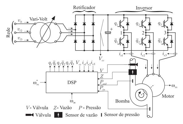
Figura 2.15: Diagrama do sistema de ensaio da bomba.
