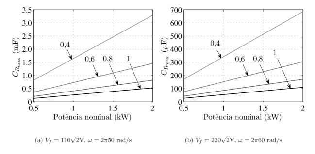
Figura 8.13: Capacitância máxima para  $C_R$  em função da potência nominal de operação do conversor para diferentes valores de índice de modulação  $\lambda_f$ .
