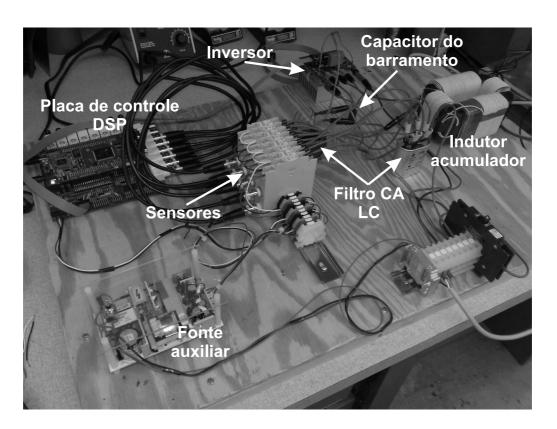
Figura 6.18: Plataforma experimental para obtenção dos resultados para o VSC.
