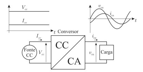
Figura 4.6: Características das formas de onda em um conversor CC-CA.
