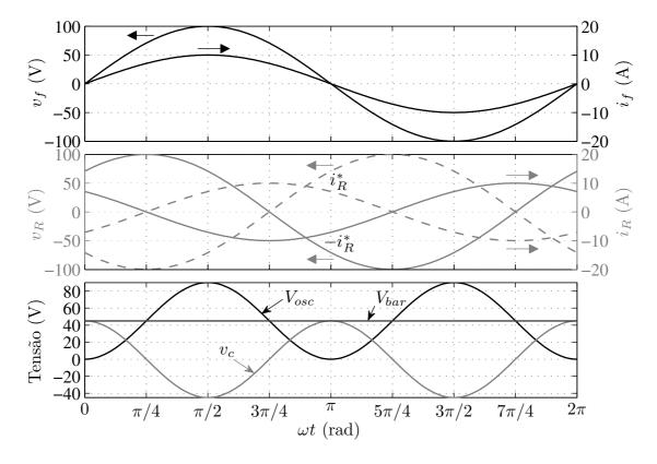
Figura 7.13: Formas de onda no CSI com compensação.
