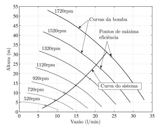
Figura 3.2: Sistema hidráulico ajustado para operar próximo dos pontos ótimos da bomba.
