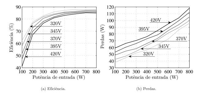
Figura 2.5: Análise das perdas do conversor push-pull.
