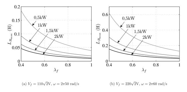
Figura 8.5: Indutância máxima para  $L_R$  em função do índice de modulação para diferentes valores de potência nominal.
