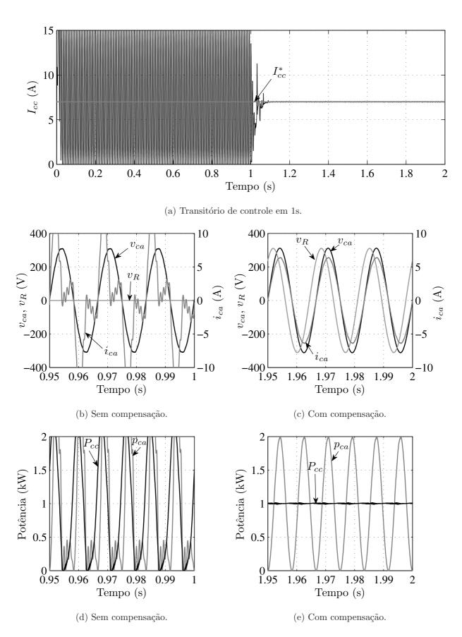
Figura 7.17: Resultado de simulação para o CSI com e sem compensação da potência oscilatória.
