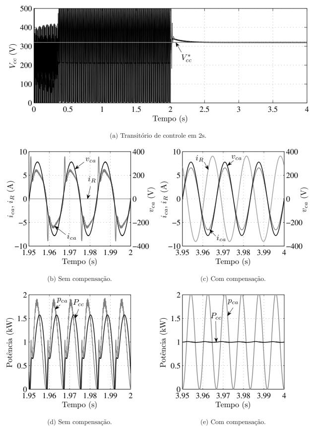
Figura 6.14: Resultado de simulação para o VSR com e sem compensação da potência oscilatória.
