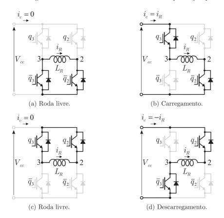
Figura 8.2: Estágios de chaveamento no conversor de compensação para  $i_R < 0$ .
