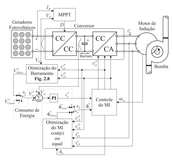
Figura 3.1: Diagrama de controle completo do sistema de bombeamento fotovoltaico otimizado.
