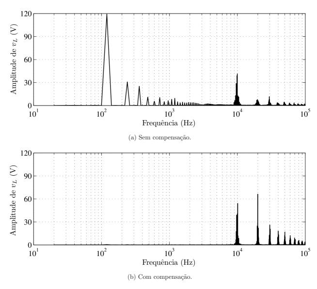
Figura 7.18: Espectro das frequências da tensão  $v_L$  sobre o indutor do barramento para o CSI.
