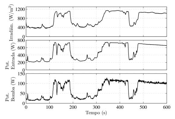
Figura 3.7: Potência do sistema operando sem otimização. De cima para baixo: perfil de irradiância; potência fornecida pelos geradores fotovoltaicos; e potência hidráulica.
