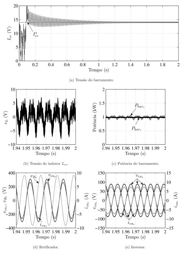
Figura 7.26: Resultado de simulação para o CSR-CSI monofásico-trifásico abaixador com compensação da potência oscilatória.
