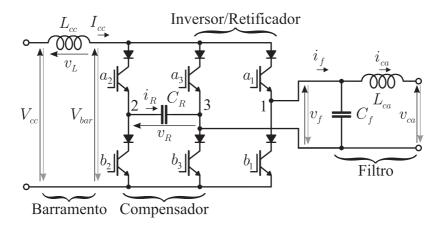
Figura 7.1: Circuito do CSC monofásico com compensador da potência oscilatória.
