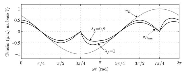
Figura 8.11: Tensão mínima e tensão praticada no capacitor de compensação do CSC em p.u..
