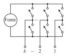
Figura 4.4: Concepção do inversor/retificador genérico com k fases.
