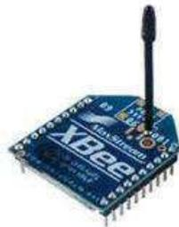
Figura 8: Ilustração do módulo transceptor ZigBee.
