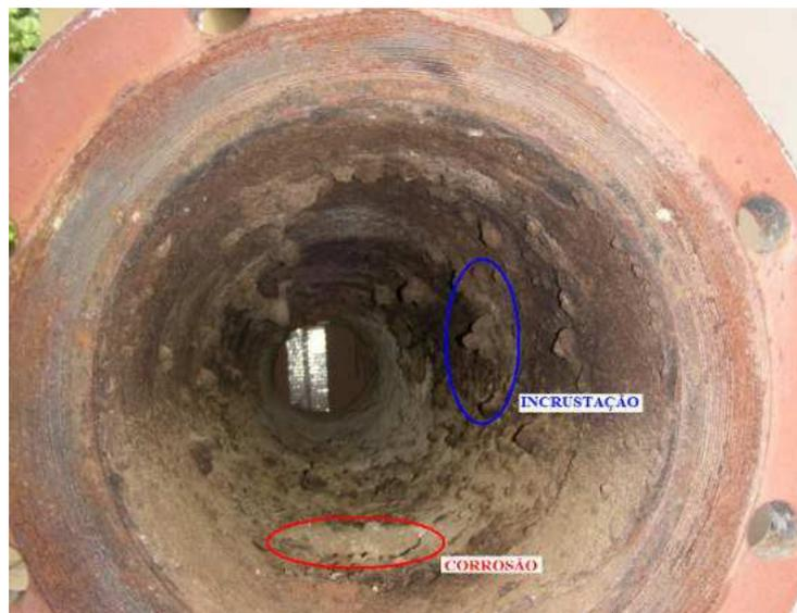
Figura 1: Foto ilustrativa das paredes internas de uma tubulação de petróleo. Fonte: Petrobrás
