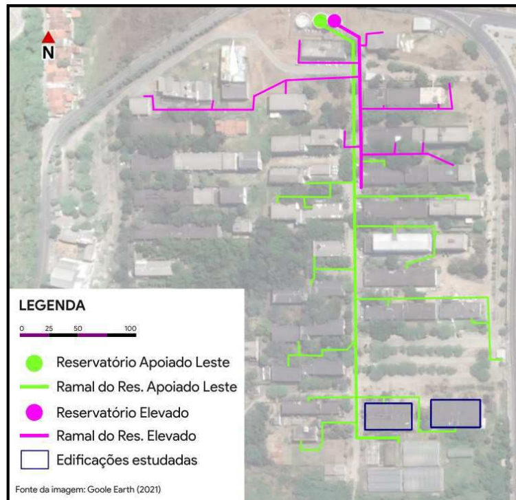
Figura 16 – Rede de abastecimento de água do setor C2 da UFCG, campus sede
