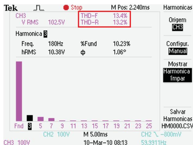
(b) THD da tensão de fase na rede ( $v_{g1}$ ) ( $THD_{v_{g1}}=13,4\%$ )
