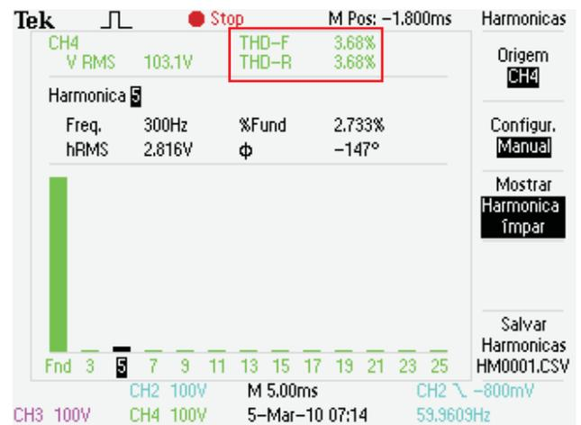
(b) THD da tensão de fase na carga ( $v_{l1}$ ) ( $THD_{v_{l1}}=3,68\%$ )
