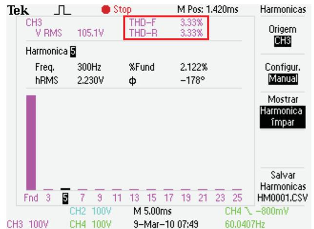
(b) THD da tensão de fase na carga ( $v_{11}$ ) ( $THD_{v_{11}}=3,33\%$ )
