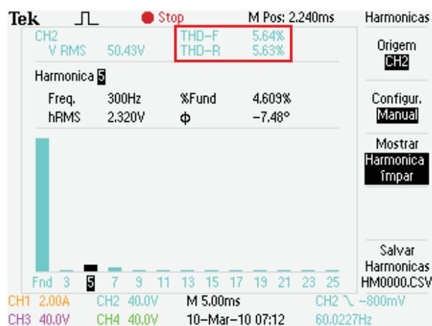
(c) THD da tensão de fase na carga ( $v_{l1}$ ) ( $THD_{v_{l1}}=5,64\%$ )
