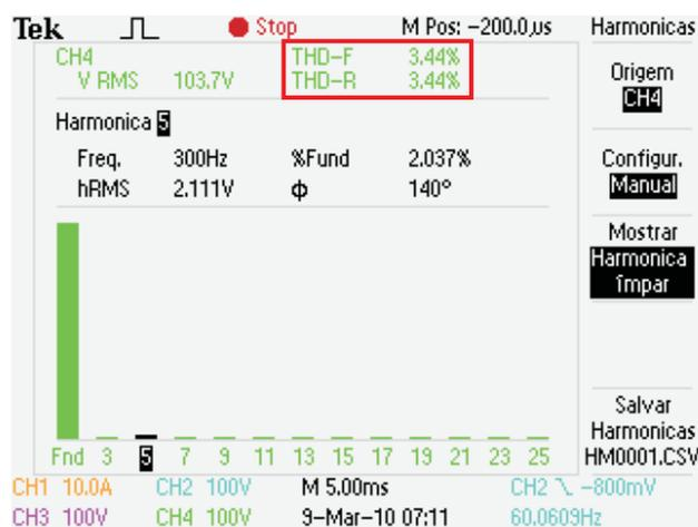
(b) THD da tensão de fase na carga ( $v_{11}$ ) ( $THD_{v_{11}} = 3,44\%$ )
