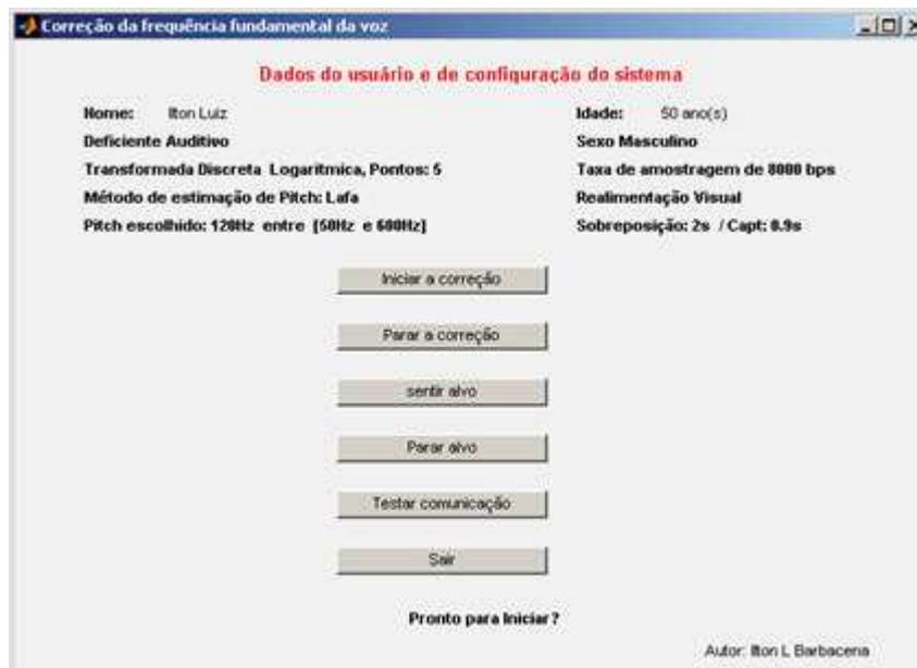
Figura 4- 8 Módulo de correção da frequência fundamental
