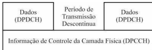
**Figura 2.21** Transmissão paralela dos DPDCH/DPCCH com a presença/ausência de dados.
