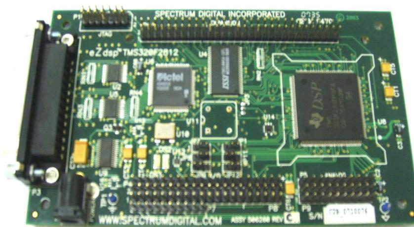
**Figura 2.8** – Plataforma eZdsp F2812 da Spectrum Digital Inc.
