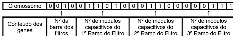
Figura 13. Estrutura de um cromossomo para projeto de 3 filtros harmônicos numa única barra do sistema.
