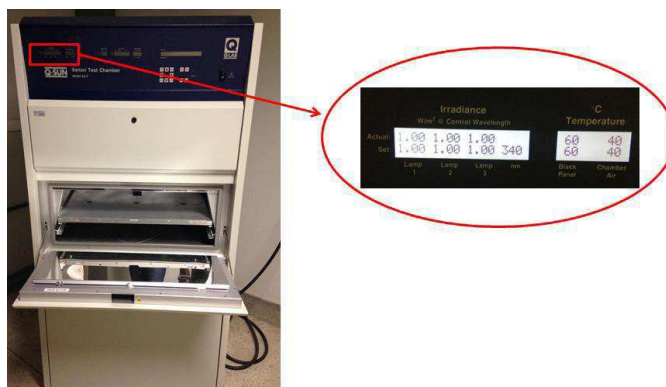
Figura 9 - Imagens da câmara de envelhecimento acelerado (Weatherometer)
