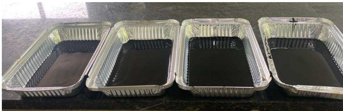
Figura 26 – Amostras de ligantes envelhecidos por radiação UV
