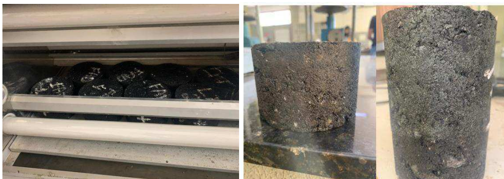
Figura 42- Corpos de prova envelhecidos na câmara UV
