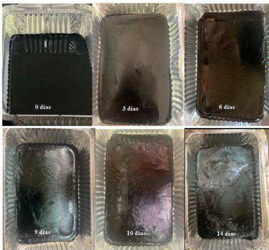
Figura 26 – Amostras de ligantes envelhecidos por radiação UV
