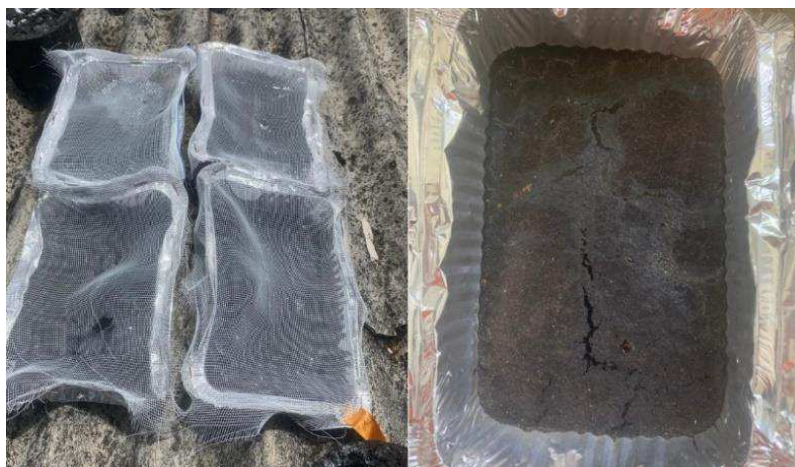
Figura 35- Amostras de ligantes submetidos as intempéries e a aparência destes após o envelhecimento.
