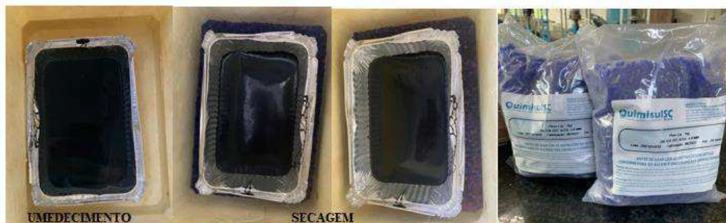
Figura 32- Amostras de ligantes submetidas a umedecimento por meio de água destilada e secagem por meio de sílica em gel.
