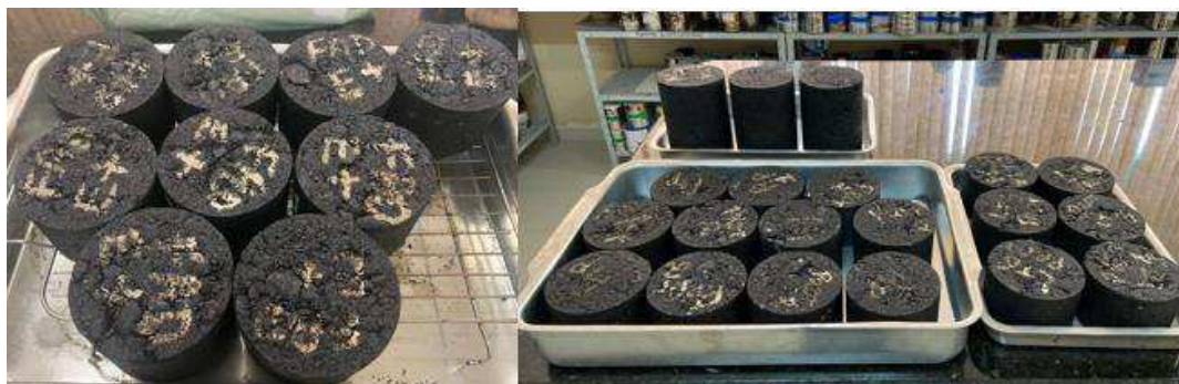
Figura 48 - Corpos de prova acondicionados à temperatura ambiente após o envelhecimento
