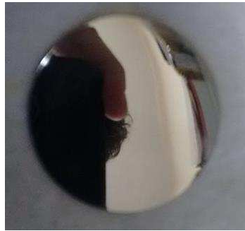
Figura 5 - Amostra do aço API 5L X70 lixada e polida
