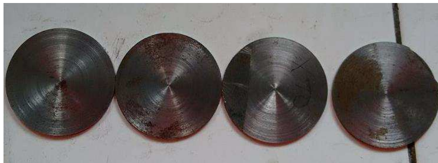
Figura 4 - Amostras cortadas do API 5L X70
