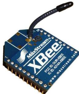
Figura 21: Módulo XBee
