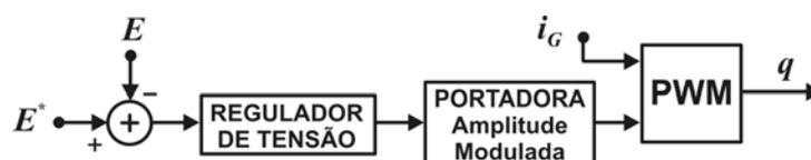
Figura 1.16: Esquema para controle de um ciclo sem malha nem referência de corrente.
