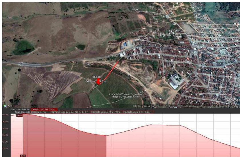
Figura 6. Trajetória transversal do terreno, constando elevação em vermelho do topo até parte mais baixa.
