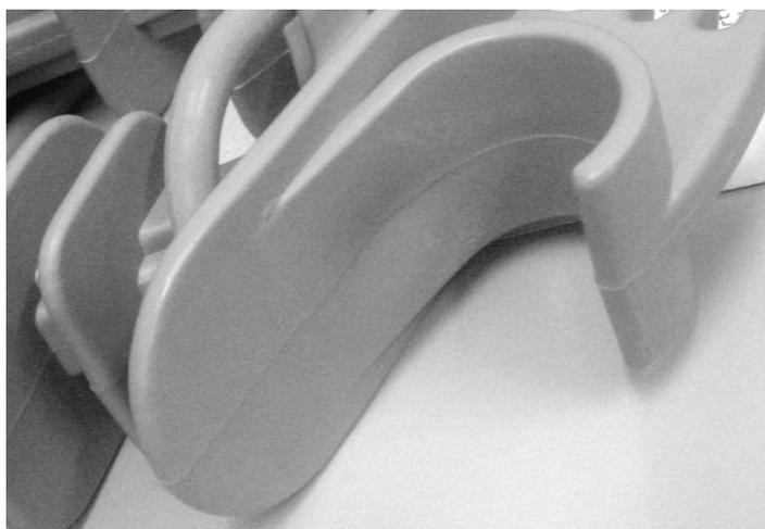
Figura 4.3. Fotografia das imperfeições dos espaçadores novos.
