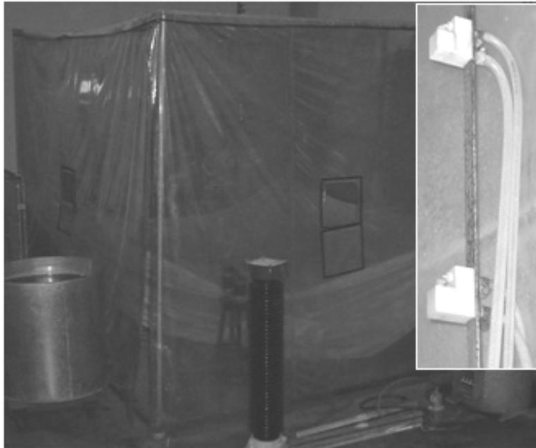
Figura 3.4. Fotografia externa da câmara de névoa salina, apresentando em detalhe uma das colunas de aspersores, localizada no interior.
