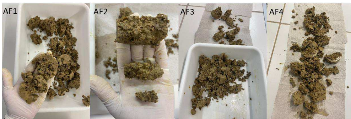
Figura 47 – Plugues formados por pellets previamente imersos em diesel, após imersão nas águas de formação sintéticas desintegrados ao tentar confeccionar os corpos de prova para os ensaios mecânicos.
