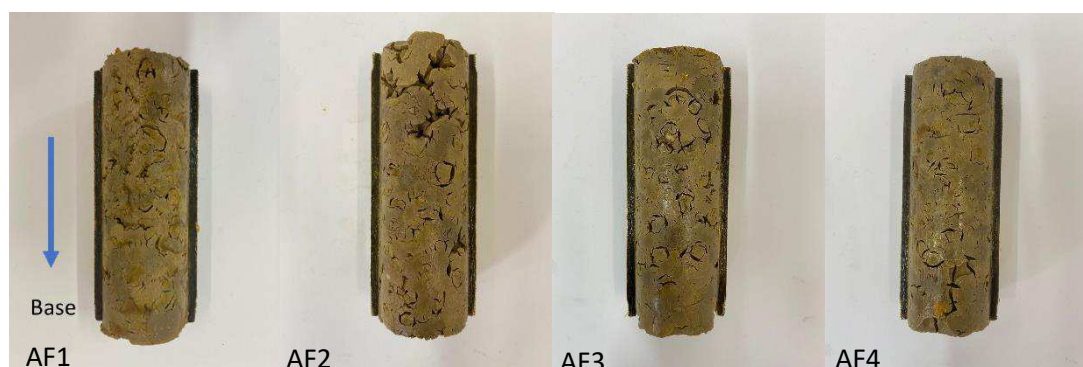
Figura 45 – Aspecto dos plugues desmoldados, após imersão em cada água de formação.
