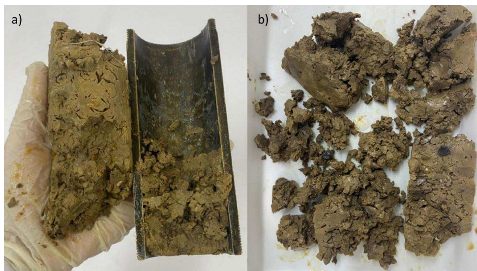
Figura 41 – Plugues formados com pellets previamente imersos em olefina (a) ao desmoldar e (b) fragmentos após o desmolde.
