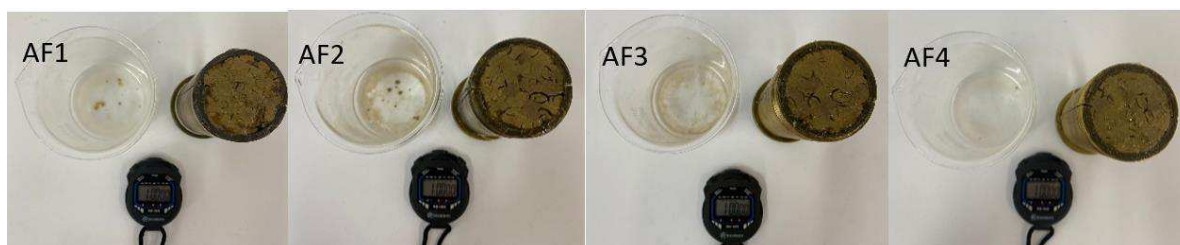
Figura 44 – Aspecto das águas de formação e da base dos plugues após a imersão.
