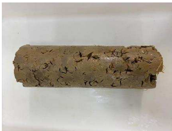
Figura 39 – Plugue desmoldado formado por pellets de bentonita.
