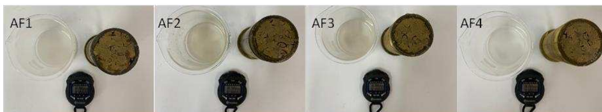
Figura 43 – Aspecto das águas de formação e da base dos plugues antes da imersão.
