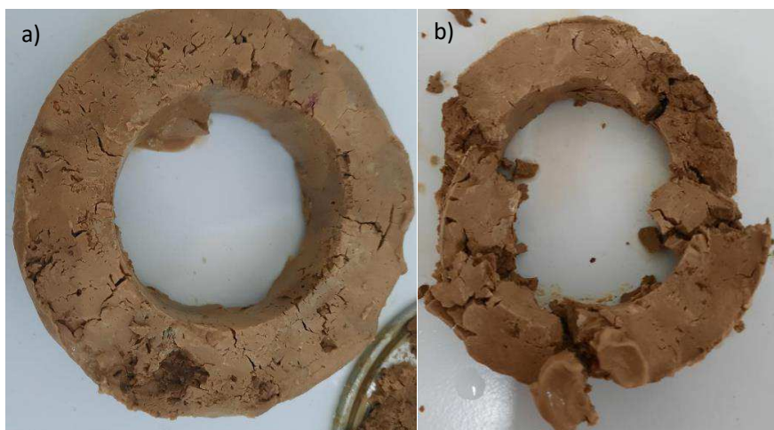
Figura 37 – Massa de pellets com imersão prévia nos meios oleosos (a) diesel e (b) olefina, após hidratação em água deionizada.
