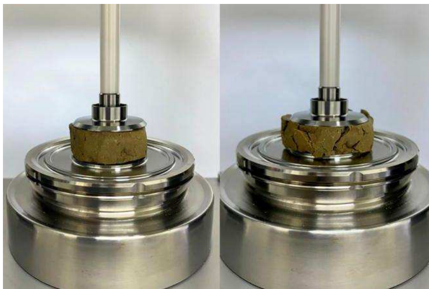
Figura 19 – Ensaio de resistência à compressão em andamento.
