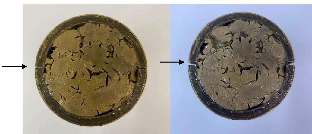
Figura 46 – Aumento da abertura entre as placas curvadas do molde metálico em virtude do inchamento da seção da base do plugue imerso na AF3.
