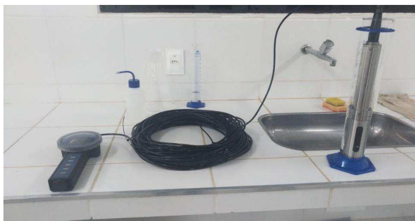
Figura 5. Sonda Hidrolab tipo Quanta G. Fonte: laboratório de hidráulica da UFCG.
