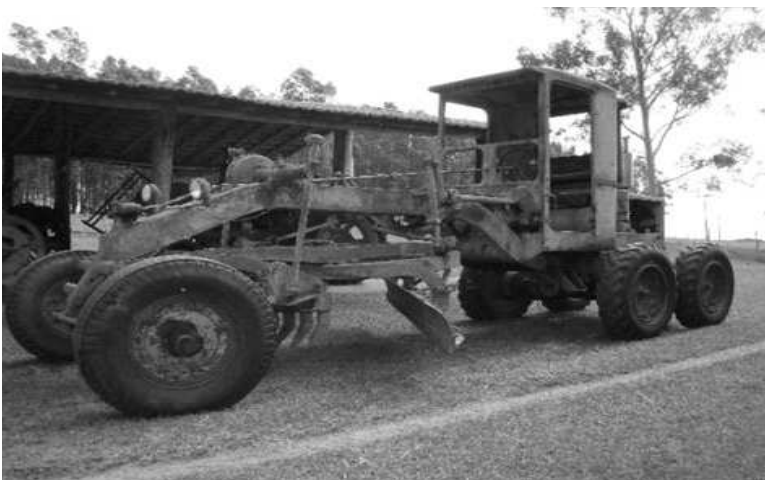
Foto 4: Motoniveladora sem hidráulicos, máquina muito importante no espalhamento do maciço de uma barragem. Fonte: Domínio público.
