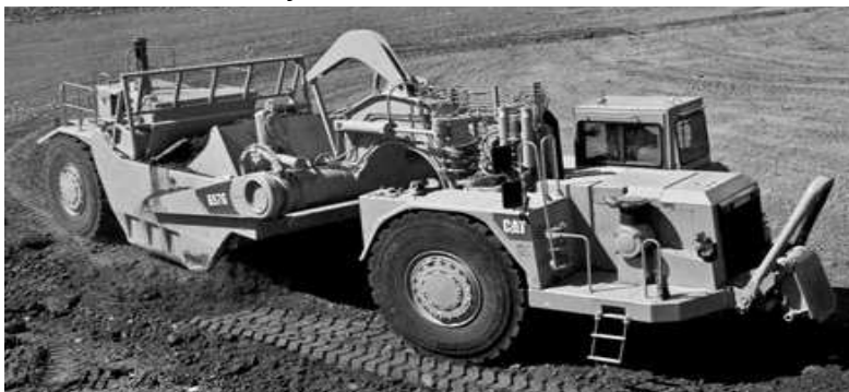
Foto 1: Moto Screaper com dois motores executando as operações de descarga e nivelamento. Fonte: Domínio Público.
