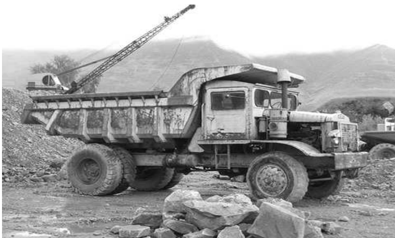
Foto 6 – Caminhão Euclides fora de estrada. Importante equipamento no transporte de materiais a granel – observa-se que são veículos para pequenas distâncias pois não possuem suspensão no eixo traseiro.
