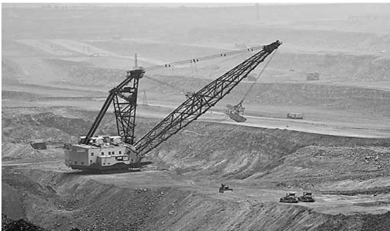
Foto – 5: Escavadeira (draga) totalmente comandada Por sistemas de capos de aço. Agilidade no carregamento de caminhões fora de estrada.
