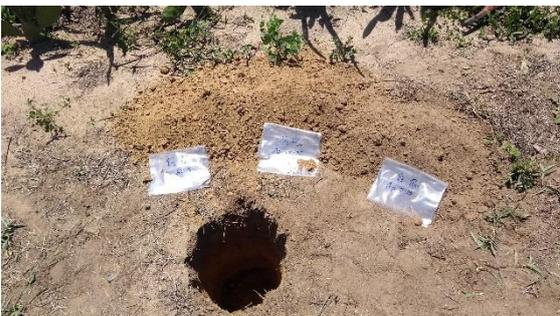
**Figura 26** - Ponto de coleta contendo amostras de repetição com material de diferentes profundidades em área de Roçado no município de Campina Grande-PB.
