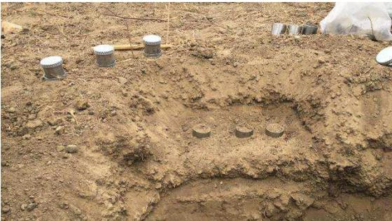
**Figura 25** - Anéis volumétricos inseridos em perfil subsuperficial.
