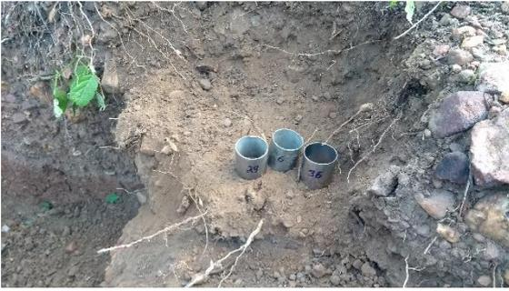
**Figura 24** - Anéis volumétricos antes de serem inseridos na camada subsuperficial.
