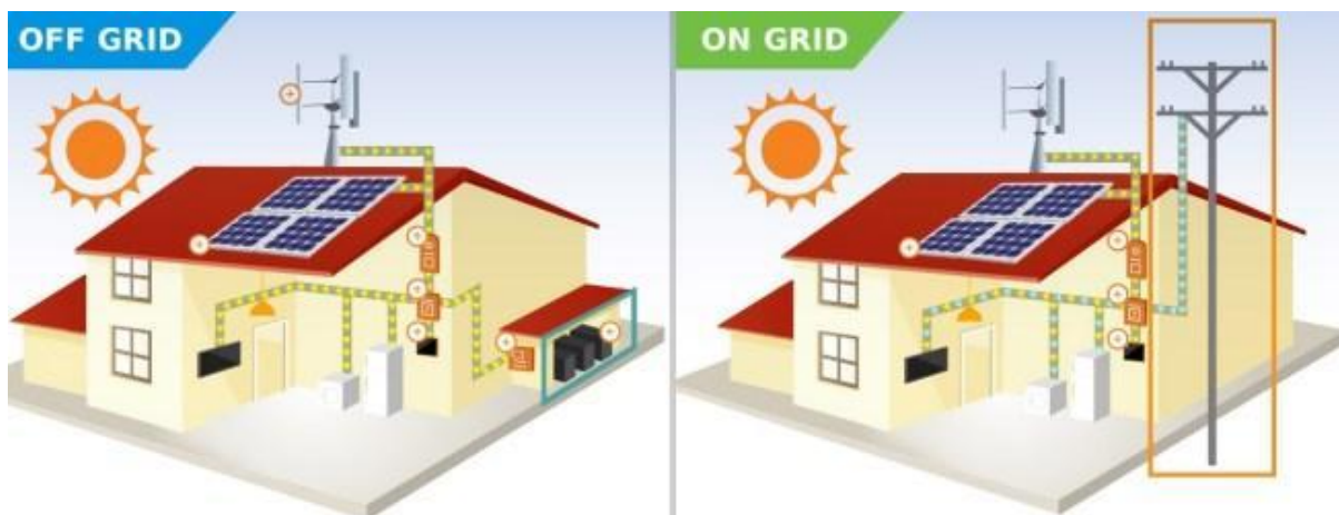
Figura 3: Modelos de sistemas de Geração Distribuída de Energia Solar Fotovoltaica On-grid e Off-grid .
