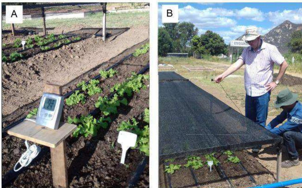
**Figura 1** - Utilização do Termohigrômetro (A) para medição da temperatura e da umidade relativa do ar e do Ceptômetro (B) para medição da radiação incidente na parte superior e inferior das tela de sombreamento. UEPB/CCHA. Catolé do Rocha-PB, 2017.
