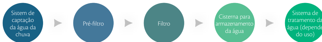
FIGURA 2 | Componentes do sistema de filtração da água da chuva para dessedentação animal.
