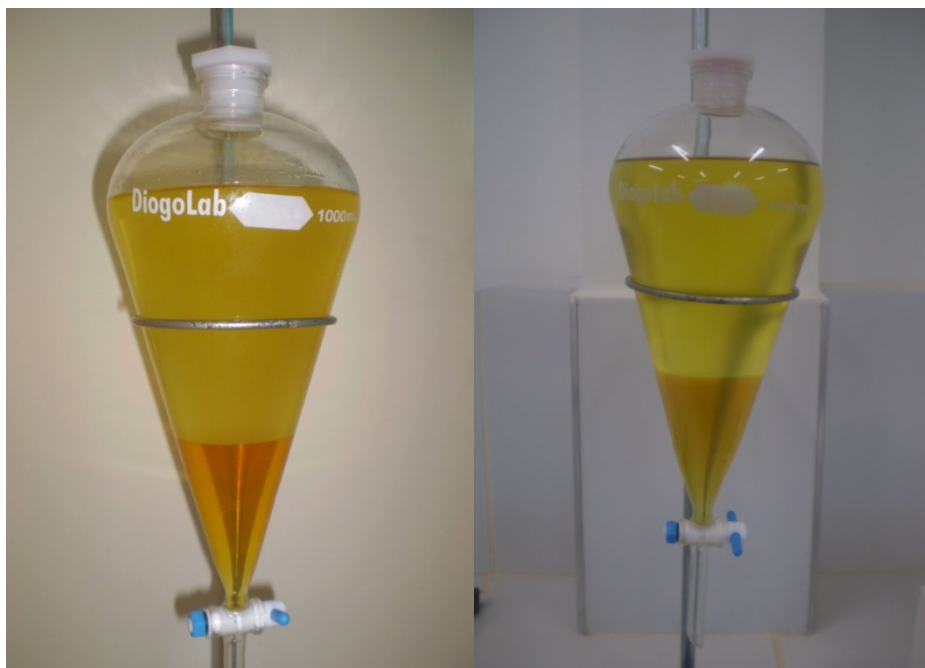
Figura 2 – Decantação dos biodieseis de maracujá rota metílica (esquerda) e etílica (direita)
