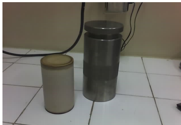
Figura 4. Imagem da autoclave de aço inoxidável (à direita) e reator de teflon (à esquerda) utilizado no processo de cristalização. Fonte: Dados da pesquisa.
