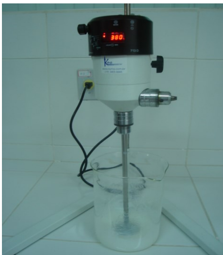
Figura 7. Aparato utilizado para a formação do gel de síntese. Fonte: Laboratório de Novos Materiais (LABNOV) – UFCG
