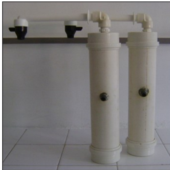
Figura 2 - Reatores sem acoplamento das bombas
