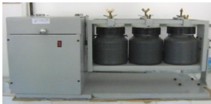
Figura 4 – Aparelho rotativo de lixiviação – NBR 10.005
