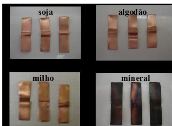
Figura 5. Fitas de cobre após ensaio de enxofre
