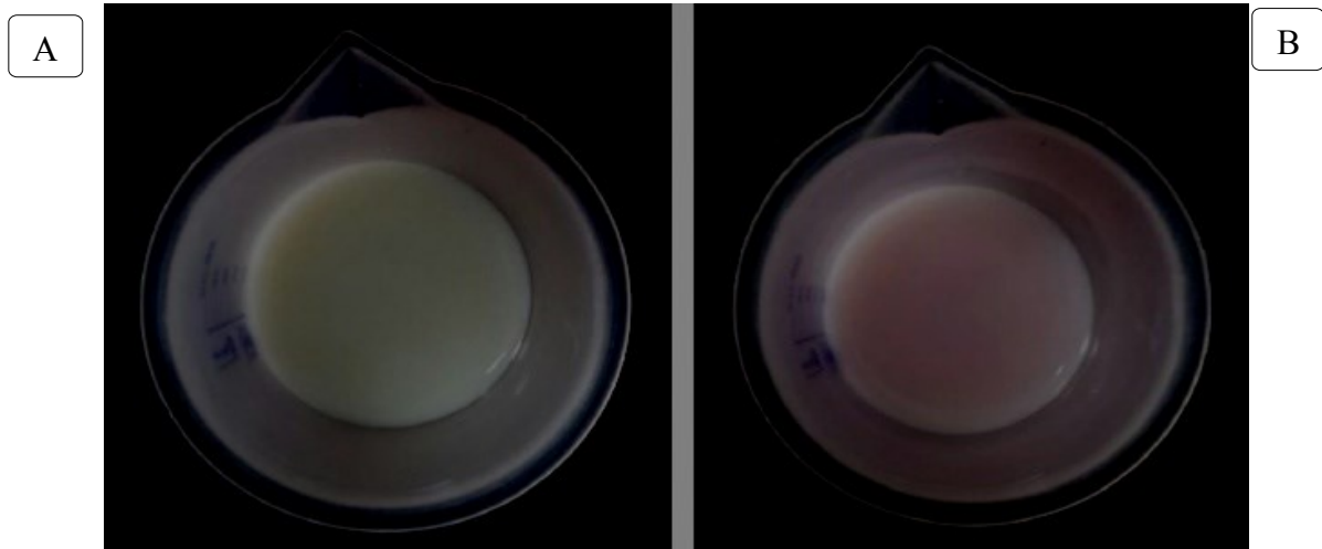
Figura 7 – Amostra recolhida para realização da acidez titulável expressa em graus Dornic (°D). (A): Amostra de leite Antes do teste; (B): Alteração na coloração do leite de cabra após o teste de acidez °D.
