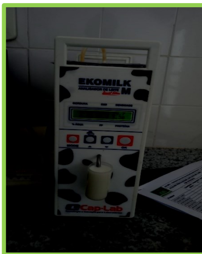
Figura 4 - Analisador de leite ultrassônico portátil para análises precisas e rápidas.
