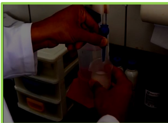
Figura 5 – Titulação de Amostra de Leite para Determinação da Acides láctica.
