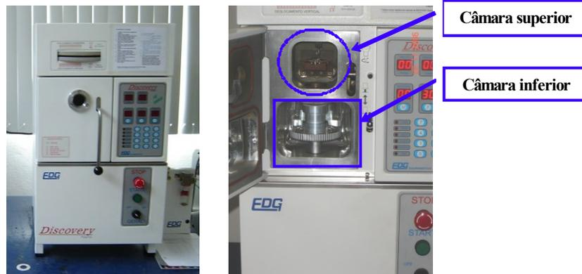
Figura 1 – Máquina de fusão a plasma Discovery All da EDG Equipamentos e controles
