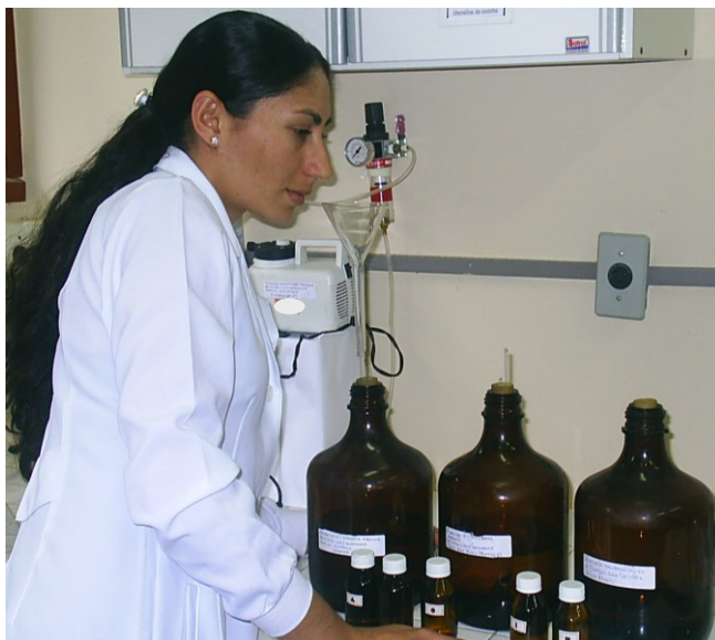
Figura 2. Foto do membro do corpo de jurados realizando teste olfatométrico da intensidade odorante no reator aerado.
