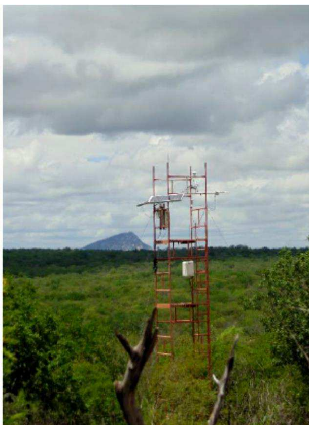
Figura 5. Torre micrometeorológica contendo sensores para medições dos componentes do balanço de radiação, instalada na caatinga preservada da Estação Ecológica do Seridó (ESEC – ICMBio) em Serra Negra do Norte, RN.
