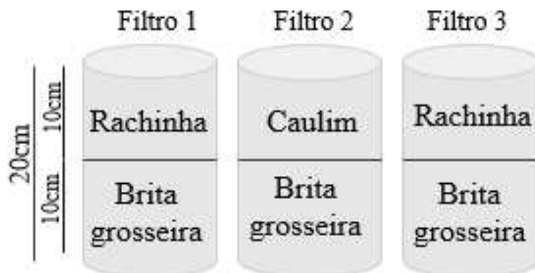
Figura 8 – Estrutura da camada suporte dos filtros
