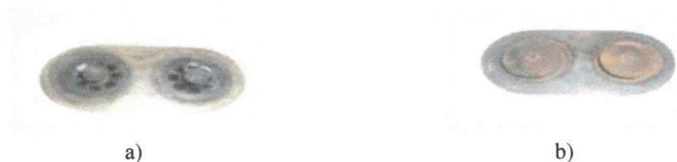
Figura 3.4 – Válvulas em bronze. a) Válvula de saída. b) Válvula de entrada
