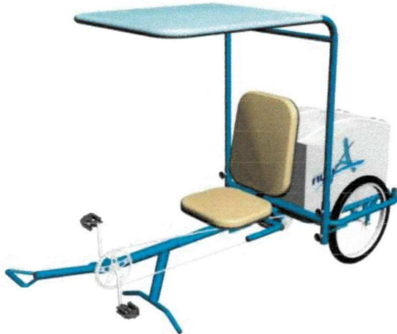
Figura 3.2 – Unidade de bombeamento à pedal acionada por propulsão humana aperfeiçoada.
