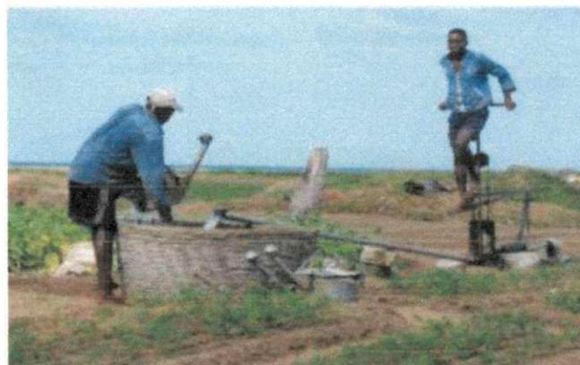
Figura2.29 – Sistema de bombeamento à pedal recalçando água de um poço.
