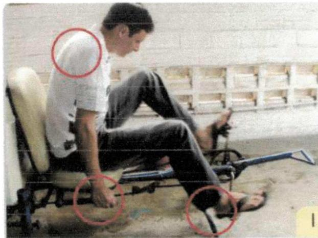
Figura 4.19 – Banco, posição das mãos , região lombar e falta de proteção para os pés.
