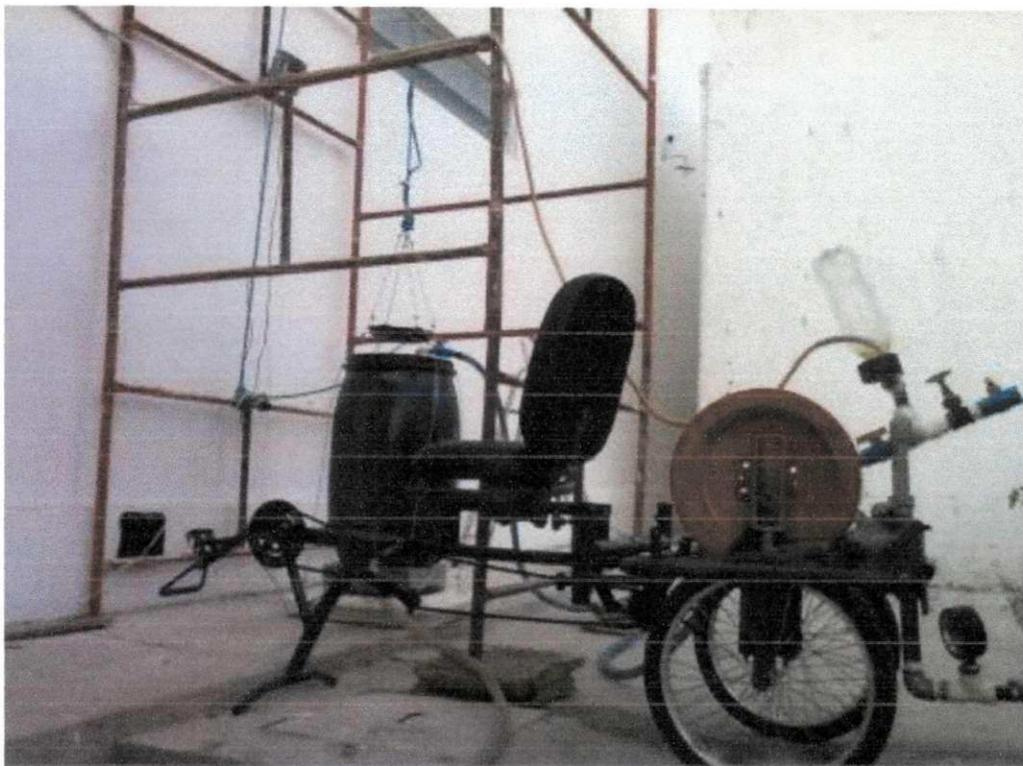
Figura 3.12 – Unidade de bombeamento à pedal pronta para uso.
