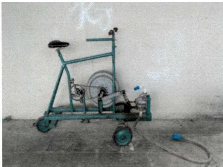
Figura 3.1- Unidade de bombeamento acionada por propulsão humana.
