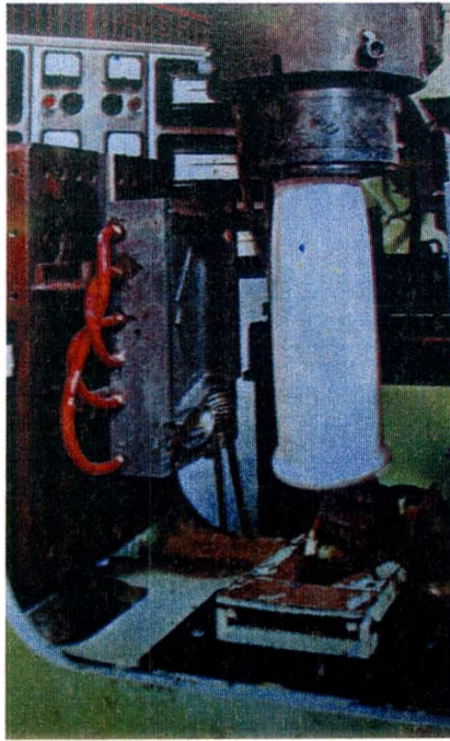
(fig.92) Processo de Extrusão, usado na fabricação de blocos, tubos metálicos e cestos de polietileno.
