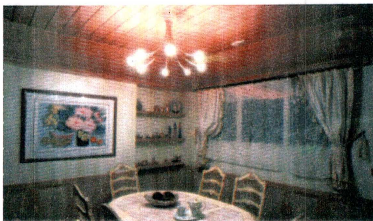
(fig.8) Luminária Spider confeccionada em alumínio, com vidro jateado nas extremidades. Lâmpada apropriada para uso é Halógena Bi-pino.
